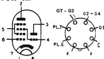
CONVERTITRICE TRIODO-ESODO. - Resistenza tra griglia schermo e alimentazione anodica 18.000 ohm, e tra griglia schermo e massa 27.000 ohm.
