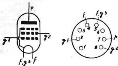
SUBMINIATURA AMPLIFICATRICE AD ALTA FREQUENZA. - Per apparecchi portatili. Accensione: 1,25 V e 25 mA. Anodica: 67,5 V e 1,7 mA. Schermo: 67,5 V e 0,5 mA. Griglia: 0 V. Resistenza interna: 0,65 MΩ. Pendenza = 1 mA/V.
