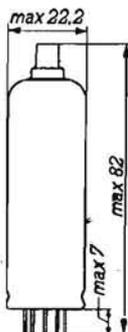
PENTODO DI POTENZA PER GENERATORI ALTA TENSIONE NEI RICEVITORI TV. - Adatto per generatore AT tipo flyback. Accensione: 21,5 V e 0,3 A. A 180 V di placca, la corrente anodica è di 45 mA a -23 V di tensione di griglia.
