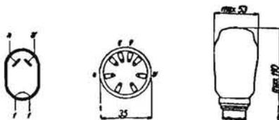
**RADDRIZZATRICE BIPLACCA A RISCALDAMENTO DIRETTO.** - Adatta per medie correnti raddrizzate. Bulbo a pera, dimensioni come la AZ4 (larghezza max 46 mm).
