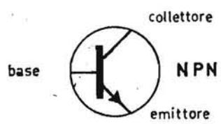
Fig. 1.3. - I transistori sono costituiti da tre sezioni di cristallo di germanio, due a conduttività positiva (P) e una a conduttività negativa (N), oppure viceversa.
