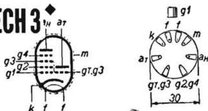
**CONVERTITRICE DI FREQUENZA** con esodo modulatore e triodo oscillatore; le due parti hanno il catodo in comune. È simile alla ECH4 con la griglia di soppressione in meno.
