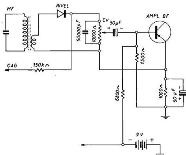
Fig. 2.8. - Stadio rivelatore con cristallo di germanio seguito da altro amplificatore a bassa frequenza a transistore.
