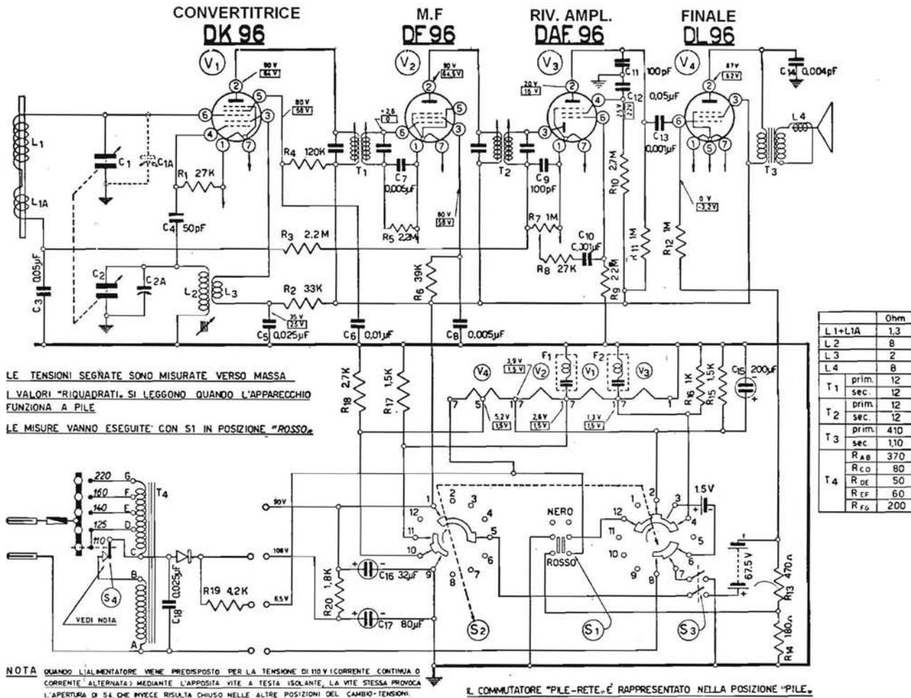
AUTOVOX - Mod. 518 - Portatile con alimentazione a pile o con corrente alternata. Gamma onde medie da 520 a 1600 kc/s. Media frequenza a 455 kc/s. Antenna in ferrite incorporata.
