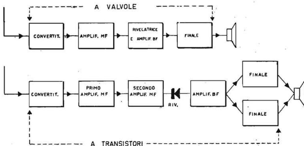
Fig. 2.1. - Schemi a blocchi di apparecchi a valvole e di apparecchi a transistori; per sostituire le valvole è necessario un maggior numero di transistori.
