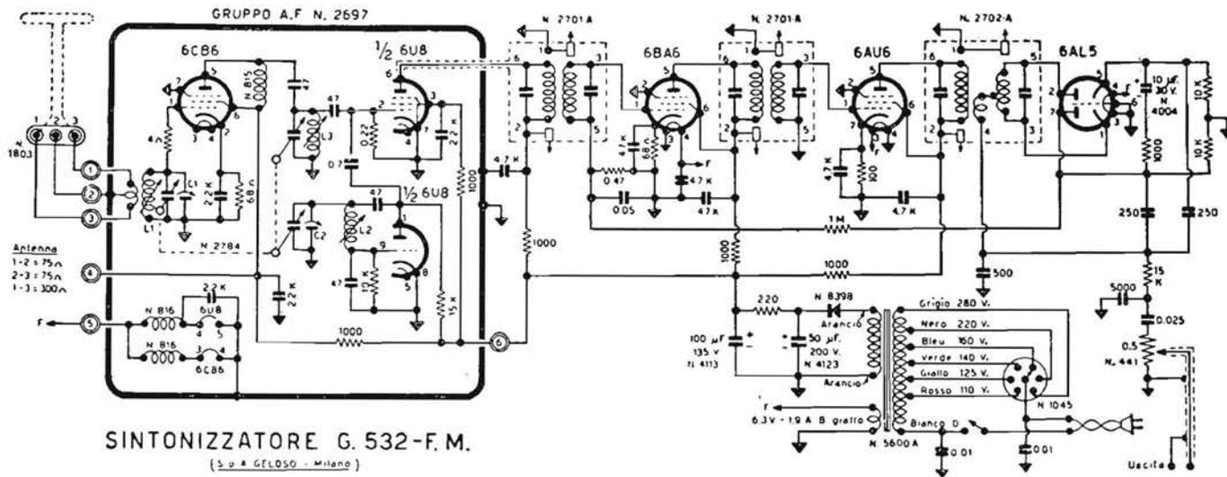
GELOSO - Sintonizzatore a modulazione di frequenza mod. G. 532 FM. Funziona collegato all'entrata di un amplificatore o alla presa fono di apparecchio radio AM. Gamma: da 88 a 108 Mc/s. MF a 10,7 Mc/s. Sensibilità d'antenna 6  $\mu$ V. Uscita BF da 5 a 7 mV.
