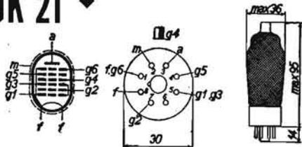
**CONVERTITRICE DI FREQUENZA PER APPARECCHI A PILE.** - Differisce dalla DCH 21 per essere un ottodo. Accensione: 1,4 V e 50 mA. Tensioni: placca e schermo 90 V, griglia anodica 60 V, griglia controllo da 0 a -6 V. Correnti: placca 1,5 mA, schermo 0,25 mA, griglia anodica 2,4 mA. Pendenza di conv. 0,5 mA/V. Resistenza interna 1,25 megohm.
