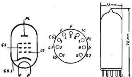
**AMPLIFICATRICE FINALE DI POTENZA DA CINQUE WATT.** - Pentodo di potenza simile alla EL84 ma adatto per funzionare con minore tensione anodica, pur consentendo la resa di uscita intorno ai 5 watt, a parità di distorsione. Può venir utilizzato solo in classe A, ossia nello stadio finale ad una sola valvola degli apparecchi radio. Zoccolo noval.
