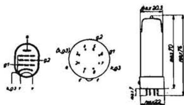
**FINALE RIMLOCK.** - Pentodo finale adatto per apparecchi senza trasformatore di tensione. Zoccolo rimlock ad 8 piedini.
