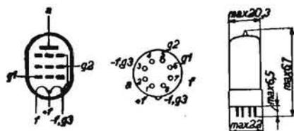
AMPLIFICATRICE FINALE RIMLOCK. - Per apparecchi a batteria. Accensione con un solo filamento (piedini 1 e 8): 1,4 V e 50 mA. Accensione con due filamenti: se in serie (piedini 7 e 8) 2,8 V e 50 mA; se in parallelo (piedini 1 e 7-8 uniti) 1,4 V e 100 mA. Tensioni: placca e schermo 90 V, griglia controllo - 3 V; correnti: placca 4 mA, schermo 0,7 mA; carico 22,5 kΩ; uscita 0,16 W.
