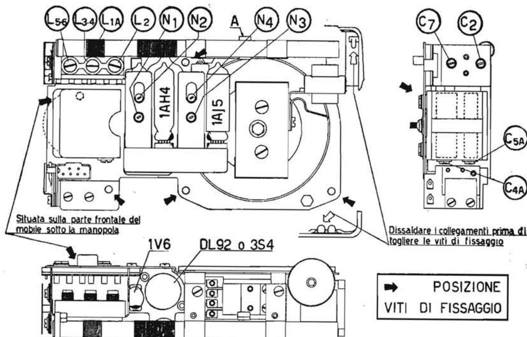
Quando il telaio viene riposto nella custodia è necessario assicurarsi, prima di applicare le viti di fissaggio, che il dentino di aggancio posto fra l'antenna ferroxcube e l'interruttore vada ad incastrarsi nell'apposita fenditura della custodia. L'operazione è agevolata premendo dall'esterno la custodia in corrispondenza del punto indicato con A
