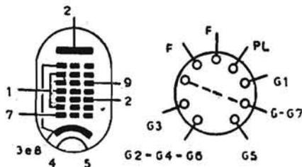
ENNEODO RIVELATORE A MODULAZIONE DI FREQUENZA. - Le griglie 2,4 e 6 sono riunite e collegate ad una presa tra due resistenze di 34.000 e di 3900 ohm, quest'ultima collegata al catodo.
