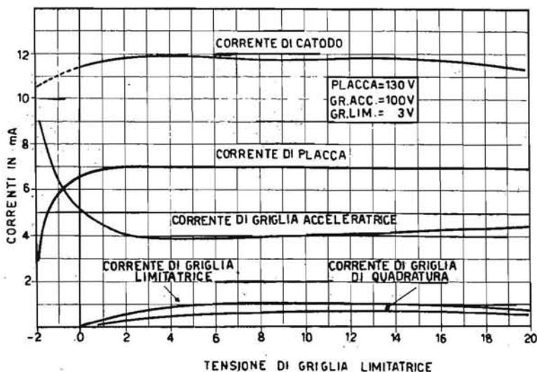
Fig. 3.24. - Curve caratteristiche di corrente della valvola 6BN6.
