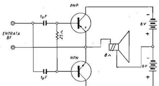
Fig. 2.12. - Utilizzando nello stadio finale un transistor tipo PNP e uno NPN è possibile eliminare i trasformatori d'entrata e d'uscita.
