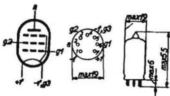
AMPLIFICATRICE A MEDIA FREQUENZA. - Valvola miniatura, adatta per apparecchi a batteria. Accensione a 1,4 V e 50 mA. Tensione anodica e schermo 45 V, corr. anodica 1,7 mA, corr. schermo 0,7 mA, tensione griglia 1, da 0 a -10 V. Tensione anodica e schermo 67,5 V, corr. anodica 3,4 mA, corr. schermo 1,5 mA, tensione griglia 1, da 0 a -16 V, pendenza 0,87 mA/V.
