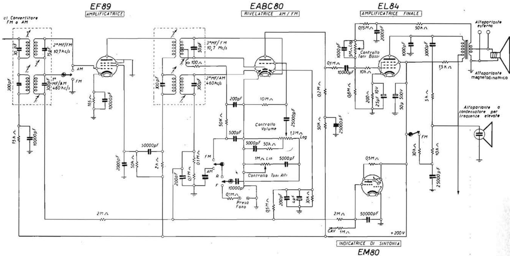
Fig. 3.36. - Schema degli stadi di rivelazione e di amplificazione ad audio frequenza di apparecchi AM/FM di medie dimensioni.
