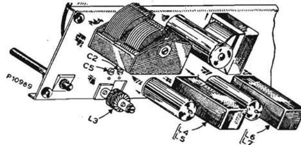
RADIO MARELLI - Portatile mod. 160. Onde medie da 520 a 1640 kc/s. MF a 455 kc/s. Regolare L1 a 600 kc/s, e C2 a 1500 kc/s. Potenza d'uscita 1,2 watt; consumo 30 watt.
