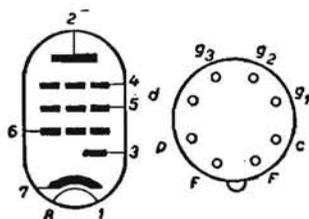
PENTODO A PENDENZA VARIABILE CON DIODO. - Rimlock simile alla EAF 41, dalla quale differisce per la maggiore pendenza, di 2 anzichè di 1,8 mA/V, e perchè ha la g3 separata dal catodo. Va usata con resistenza in serie alla griglia schermo di 110 000 ohm, anzichè 95 000 ohm.
