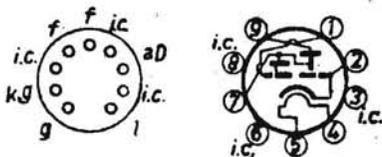
INDICATRICE DI SINTONIA. - È una indicatrice a raggio catodico adatta sia per ricevitori AM che FM. Va montata verticalmente. Zoccolo noval. È identica alla EM80 dalla quale differisce per l'accensione a 19 V e 0,1 A.
