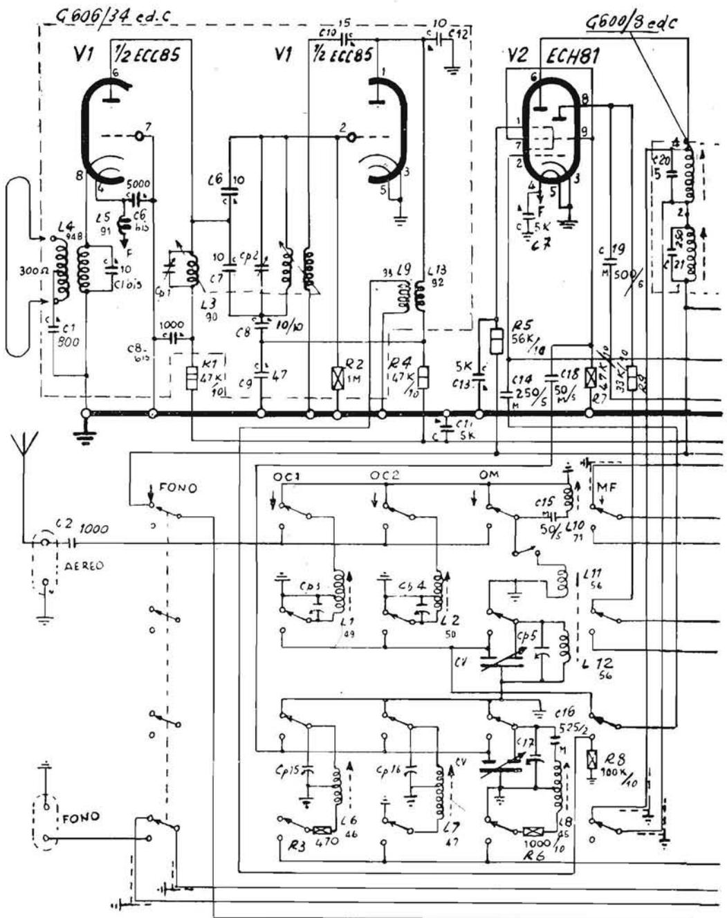
ALLOCCIO BACCHINI - Mod. 962 MF. Apparechio a modula una OM, due OC e una UC a FM. Media frequenza AM a 465 kc/s,
