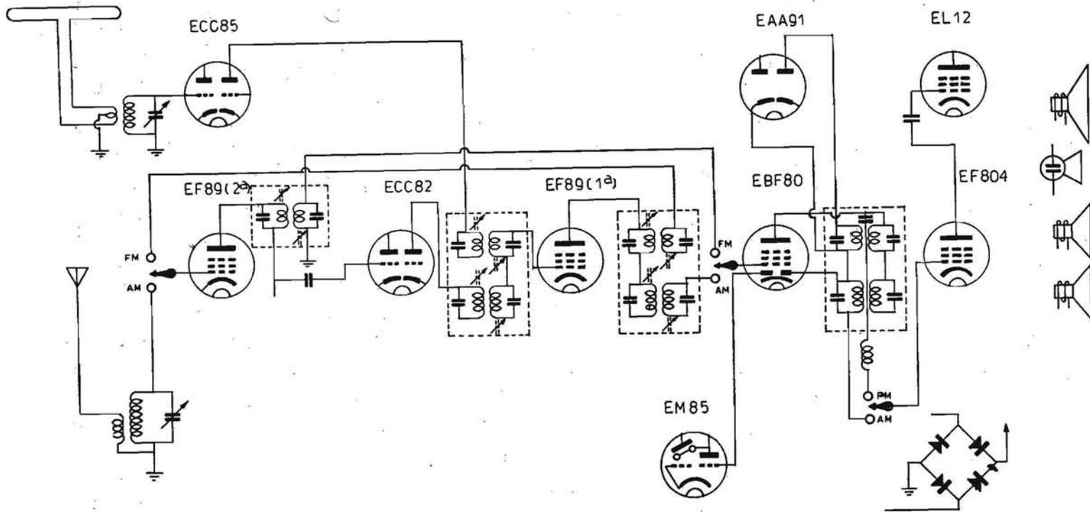
Fig. 3.27. - Funzione delle varie valvole in apparecchio AM/FM di elevata qualità tipo 3D (Grundig).
