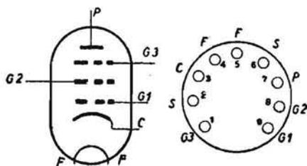
PENTODO AMPLIFICATORE PER AF A BASSO RUMORE. - Zoccolo tipo noval. Caratteristiche simili alla EF804, da cui differisce per la minore corrente di accensione, di 0,17 A.
