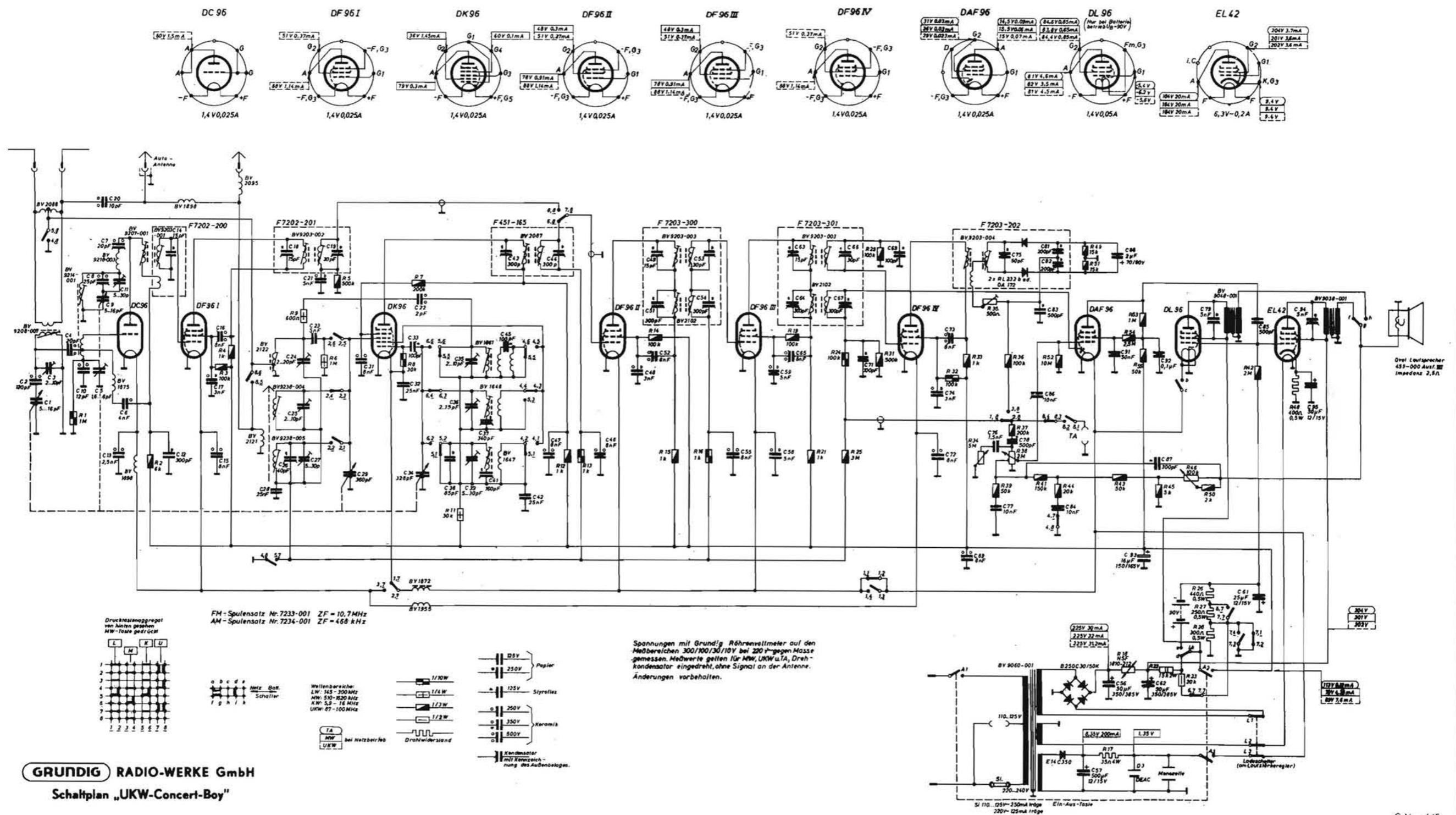
GRUNDIG (Radio Werke GmbH) - Mod. Concert Boy. Portatile pile-rete a modulazione d'ampiezza e di frequenza. Due diodi al germanio per la rivelazione FM. Onde lunghe, medie, corte e FM. Media frequenza AM a 468 kc/s e FM a 10,7 Mc/s. Il raddrizzatore anodico incorporato ricarica automaticamente, durante l'ascolto con rete-luce, la batteria d'accensione. Antenna interna in ferrite.
