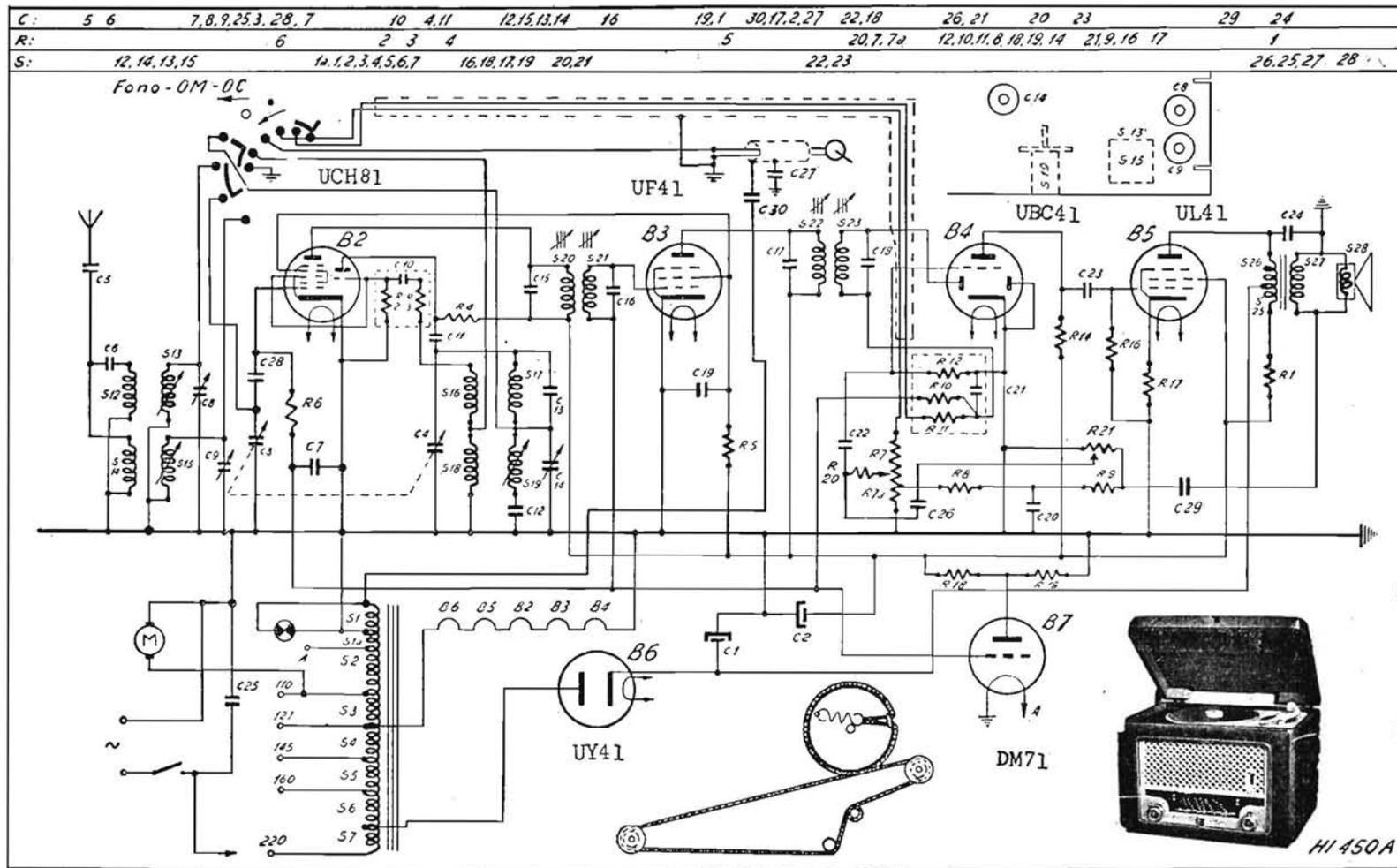
PHILIPS RADIO - Mod. HI 450/A - Onde medie e onde corte. Media frequenza a 460 kc/s. Potenza d'uscita 2 watt. Consumo 30 watt.
