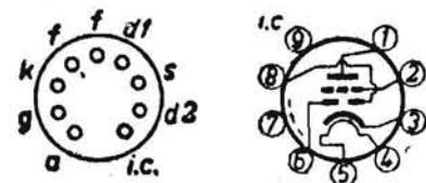
DOBPIO DIODO RIVELATORE E TRIODO AMPLIFICATORE BF. - Valvola rivelatrice AM/CAV e amplificatrice BF. Zoccolo noval.
