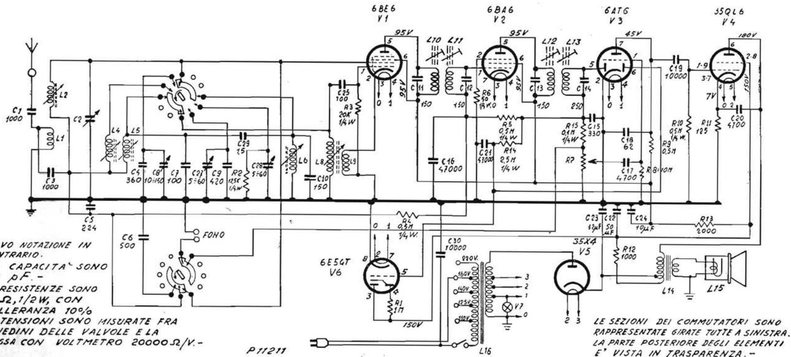
RADIO MARELLI - Mod. 165 - Apparecchio a permeabilità variabile. Gamma onde medie, gamma onde tropicali e banda allargata onde corte. MF a 455 kc/s. Potenza d'uscita 2,5 watt. Consumo 50 watt.
