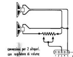
schema illustrativo delle connessioni tra le varie parti dell'apparecchio e del collegamento con altoparlanti supplementari.
