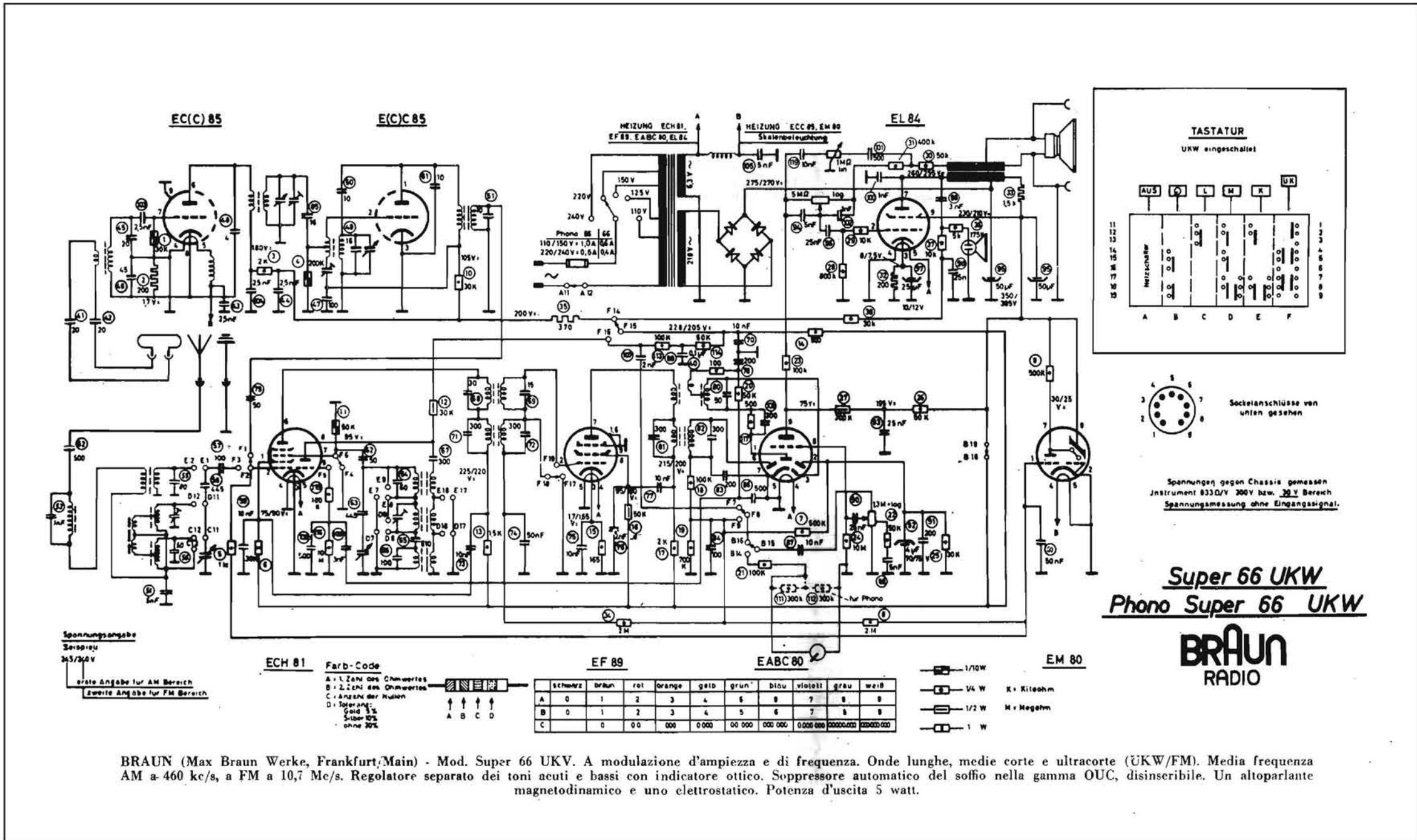
BRAUN (Max Braun Werke, Frankfurt/Main) - Mod. Super 66 UKV. A modulazione d'ampiezza e di frequenza. Onde lunghe, medie corte e ultracorte (UKW/FM). Media frequenza AM a 460 kc/s, a FM a 10,7 Mc/s. Regolatore separato dei toni acuti e bassi con indicatore ottico. Soppressore automatico del soffio nella gamma OUC, disinscrivibile. Un altoparlante magnetodinamico e uno elettrostatico. Potenza d'uscita 5 watt.
