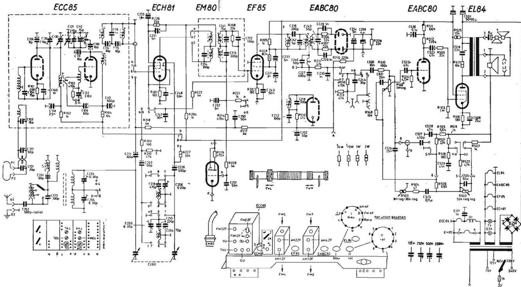
METZ RADIO APPARATEFABRIK (Capriotti) - Mod. AM/FM 308. A modulazione d'ampiezza e di frequenza. Onde lunghe, medie, corte o ultracorte (FM). Media frequenza AM a 460 kc/s, FM a 10,7 Mc/s. Antenna interna in ferrite. Tre altoparlanti. Potenza 4 watt indistorti. Consumo 45 watt.
