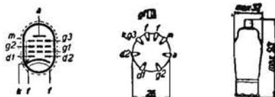
PENTODO MEDIA FREQUENZA CON DUE DIODI per la rivelazione e li cav. Precede la valvola amplificatrice BF, la quale può essere anche indicatrice di sintonia, come la EFM1. Zoccolo a contatti laterali.
