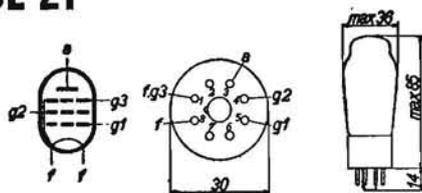
PENTODO D'USCITA PER APPARECCHI A PILE. - Accensione: 1,4 V e 50 mA. Tensioni: placca e schermo 90 V, griglia - 3,2 V. Correnti: placca 4 mA, schermo 0,7 mA. Pendenza 1,3 mA/V. Resistenza Interna 0,3 megaohm. Potenza d'uscita 170 milliwatt. Con 120 V di placca e schermo la potenza d'uscita è di 250 mW.
