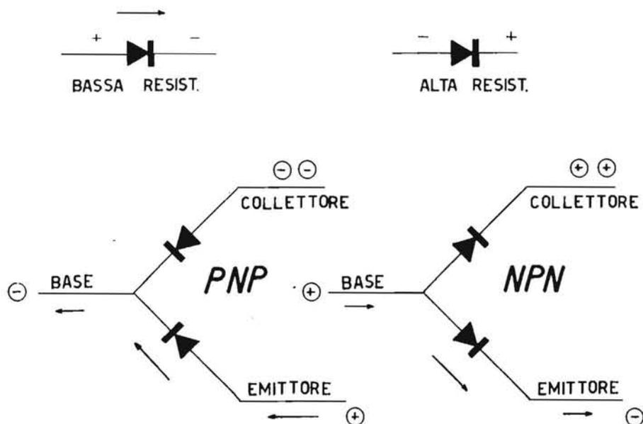
Fig. 1.8. - I transistori consistono di due diodi al germanio, disposti in un senso (PNP) o in senso opposto (NPN).
