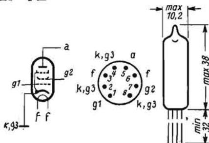
PENTODO SUBMINIATURA PER ALTA FREQUENZA. - Questo pentodo è particolarmente adatto per l'elevata pendenza di 5 mA/V a funzionare in circuiti amplificatori per elevate frequenze.
