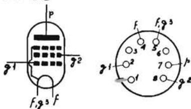
SUBMINIATURA AMPLIFICATRICE A MEDIA FREQUENZA. - Per apparecchi radio portatili. Accensione: 1,25 V e 25 mA. Placca: 67,5 V e 1,7 mA. Schermo: 67,5 V e 0,5 mA. Griglia: 0 V. Resistenza interna: 0,8 MΩ. Pendenza: 0,8 mA/V.
