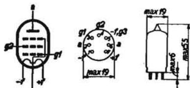
**AMPLIFICATRICE FINALE MINIATURA.** - Per apparecchi a pile. Accensione con due filamenti: se in serie (piedini 1 e 7) 2,8 V e 50 mA; se in parallelo (piedini 5 e 1-7 uniti) 1,4 V e 100 mA. Tensioni: placca e schermo 67,5 V, griglia -7 V. Correnti: placca 6 mA, schermo 1,2 mA. Carico 5 k $\Omega$ . Uscita 0,16 W.
