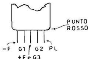
SUBMINIATURA PER OTOFONI. - Pentodo amplificatore di tensione bassa frequenza. Accensione: 0,625 V e 13,3 mA. Tensione anodica 22,5 V corrente anodica 0,05 mA, tensione schermo 18 V, corrente schermo 0,01 mA. Tensione griglia -1,15 V. Pendenza 0,1 mA/V. Resistenza interna 4 megaohm.
