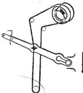
Funicella con rivestimento in nylon paraffinata, diametro 0,5 mm. Posizione corrispondente a condensatore variabile aperto.
