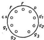
AMPLIFICATRICE MEDIA FREQUENZA E RIVELATRICE. - Pentodo con due diodi del tipo noval. Accensione: 17 V e 0,1 A.
