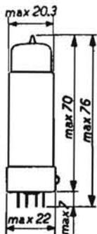
**RADDRIZZATRICE BIPLACCA RIMLOCK.** Accensione a 4,0 V e 0,72 A. Adatta per piccoli apparecchi. Fornisce 70 mA a 2x300 V e 60 mA a 2x400 o a 2x500 V. Ingresso del filtro: 50 microfarad. Zoccolo ad 8 piedini.
