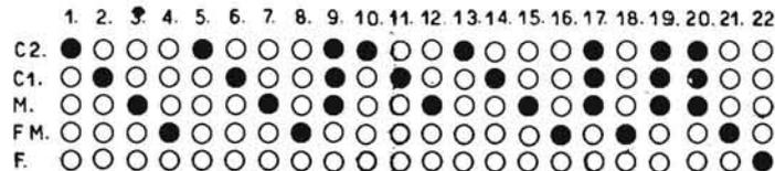
FIMI S. A. - PHONOLA mod. 729. Apparecchio a modulazione d'ampiezza e di frequenza. Onde medie da 183 a 575 m, OC1 da 27,3 a 80 m; OC2 da 15,8 a 28 m e FM da 87 a 101 Mc/s. MF/AM a 470 kc/s, MF/FM a 10.7 Mc/s. Potenza 5 watt. (Dalla matricola 301, è variato il controllo di tono).
