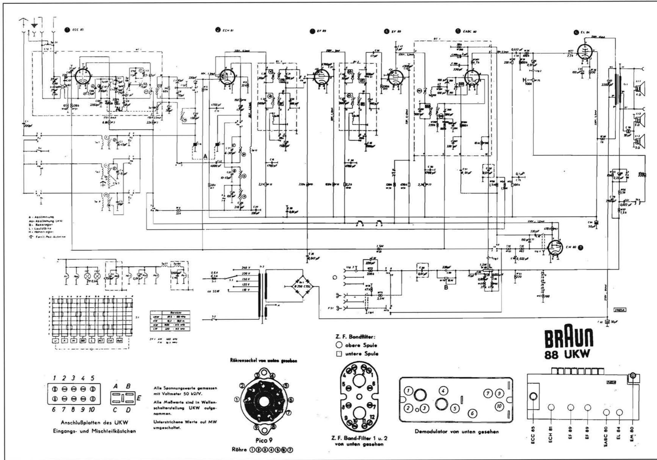
BRAUN (Max Braun Werke, Frankfurt/Main) - Mod. Super 88 UKW. A modulazione d'ampiezza e di frequenza. Onde lunghe 120-315 kc/s, onde medie 515-1620 kc/s, onde corte 16,2-50,8 metri, onde ultracorte (FM) 87,5-100 Mc/s. FM/AM a 460 kc/s, FM/MF a 10,7 Mc/s. Riproduzione elettroacustica 3D. Potenza d'uscita 6 watt. Consumo 55 watt.
