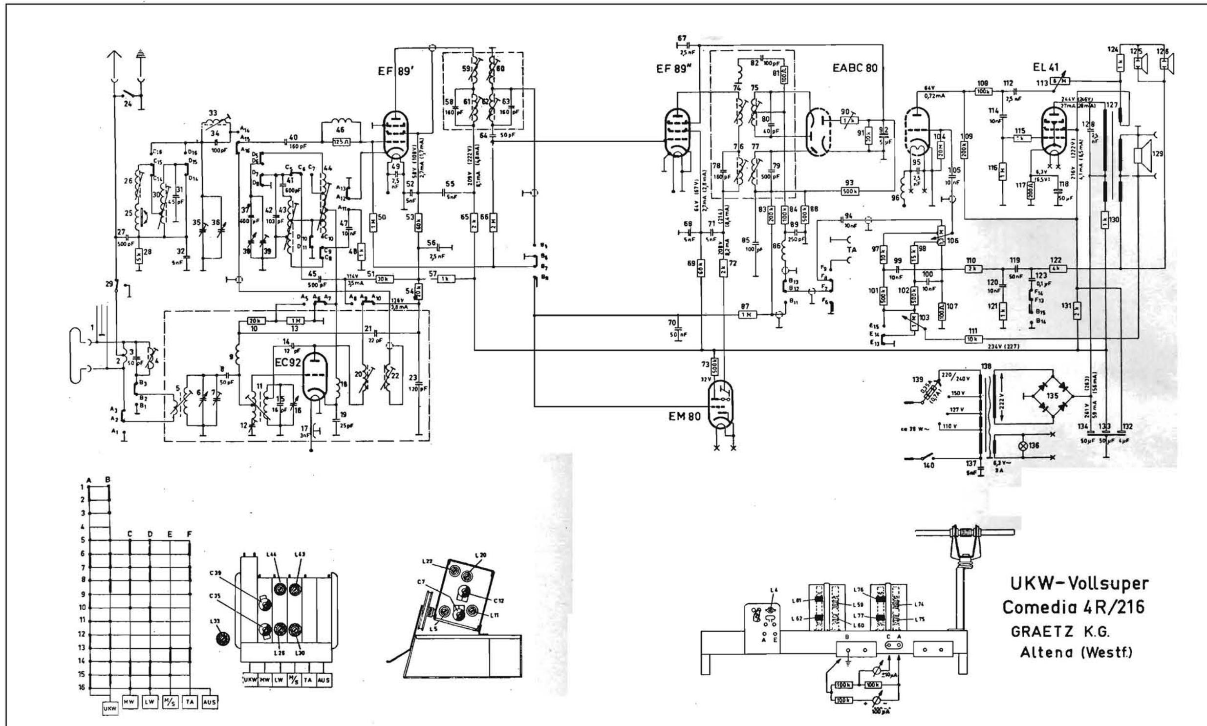
GRAETZ (Graetz Radio und Fernsehwerke, Altena) - Mod. Comedia 4R/216 - Apparechio AM/FM a quattro gamme d'onda (lunghe, medie, corte) in AM e una banda in FM (onde ultracorte). Media frequenza AM a 472 ke/s, MF/FM a 10,7 Mc/s. Riproduzione elettroacustica del tipo 3D, con un altoparlante magnetodinamico e due altoparlanti elettrostatici. Potenza d'uscita 4 watt indistorti. (Produzione 1956).
