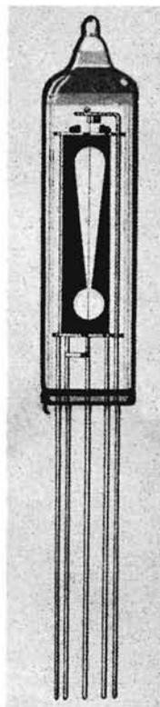
Fig. 8.1. - Subminiatura Indicatrice di sintonia DM 70.
