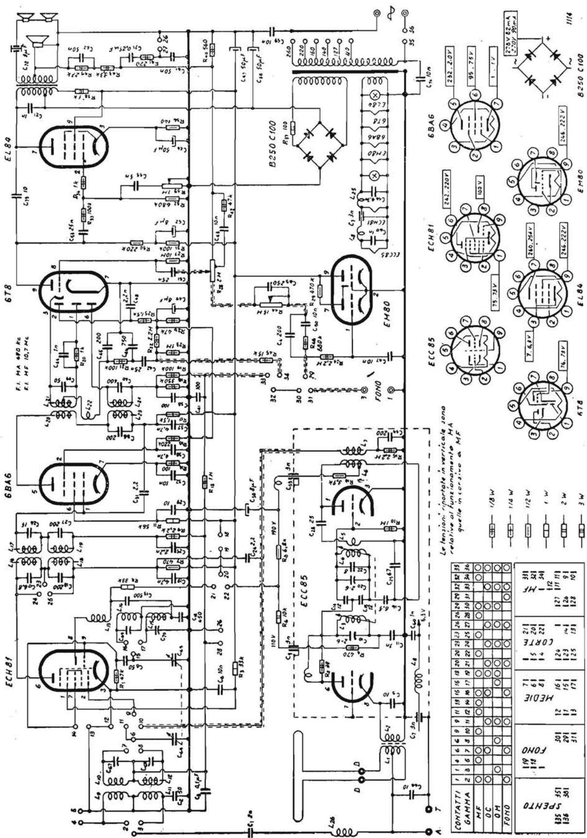
Le tensioni riportate in verticale sono relative al funzionamento MA quelle in corsivo in MF
