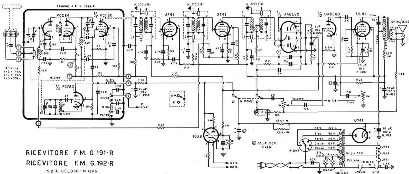
GELOSO - Modd. G.191/R e G.192/R. Ricevitore a modulazione di frequenza con entrata in cascade. Gamma da 87,5 a 101 Mc/s. MF/FM a 10,7 Mc/s. Gruppo AF n. 2699-P. Funziona anche con propria antenna interna. Sensibilità d'antenna 5 μV. Potenza d'uscita 2,5 watt. Consumo 50 watt. I due modelli differiscono solo per il diverso mobiletto.
