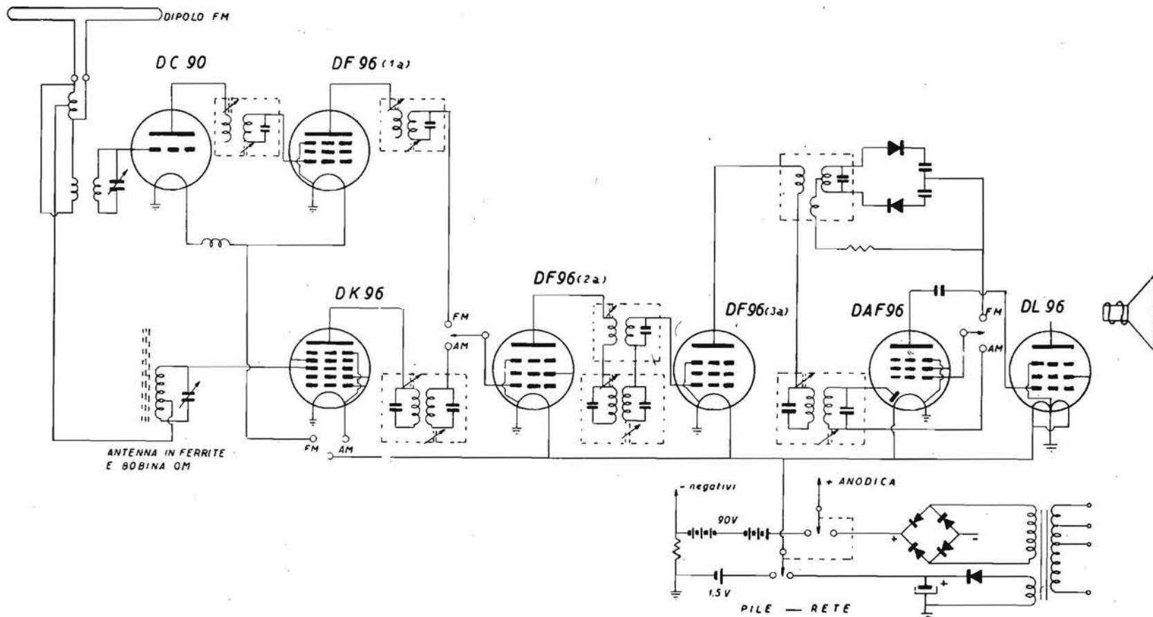
Fig. 3.39. - Disposizione e funzionamento delle valvole in apparecchio portatile a modulazione di ampiezza e di frequenza.
