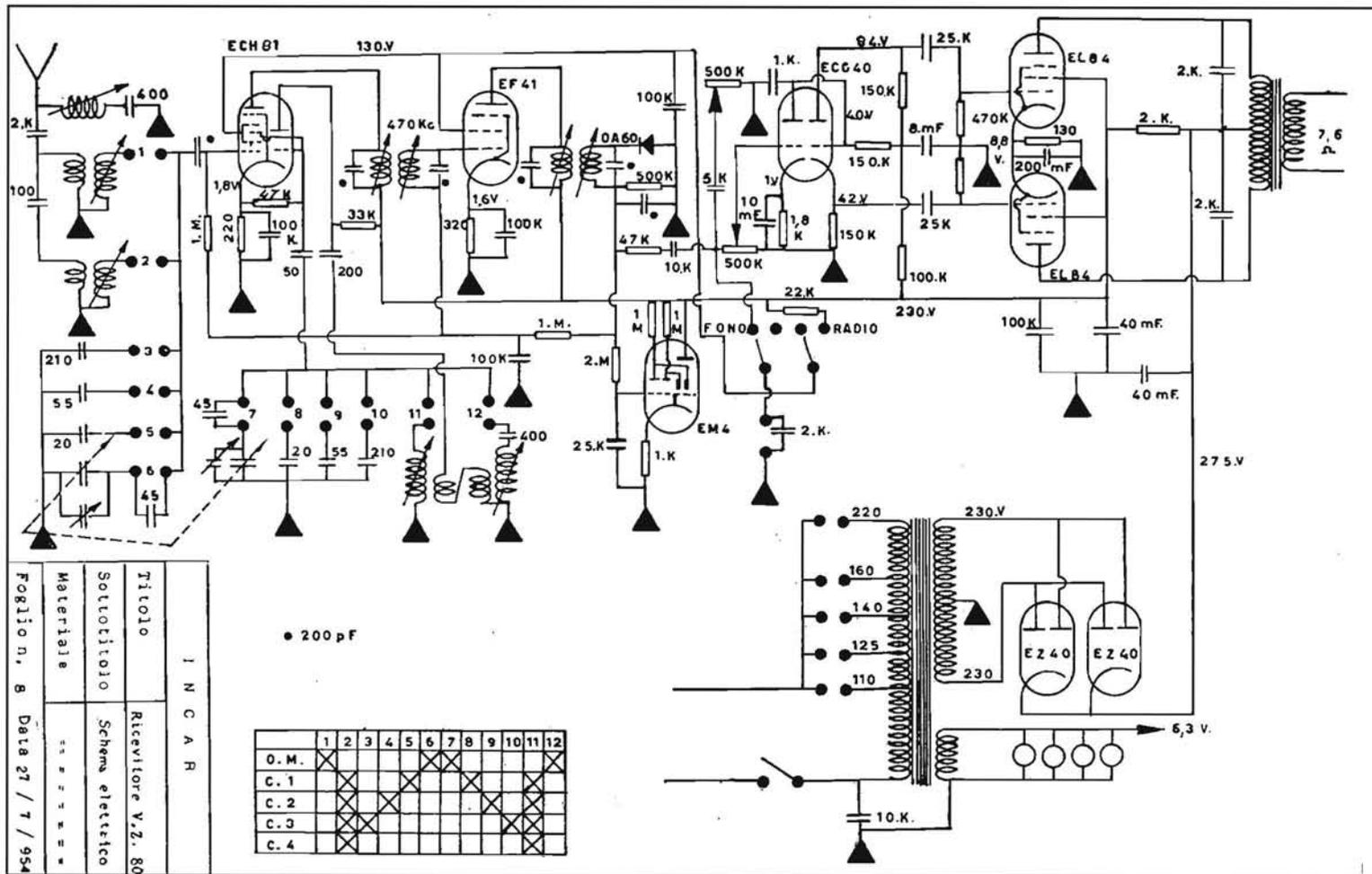
INCAR - Mod. UZ 803. Ricevitore a onde medie con quattro bande allargate in onde corte. Potenza d'uscita 8 watt. Consumo 90 watt.
