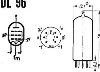
**AMPLIFICATRICE FINALE PER APPARECCHI A PILE.** - Appartiene alla serie delle valvole a 25 mA di accensione e va usata insieme con la DK 96, DF 96 e DAF 96. Accensione 1,4 V e 50 mA o 2,8 V e 25 mA.
