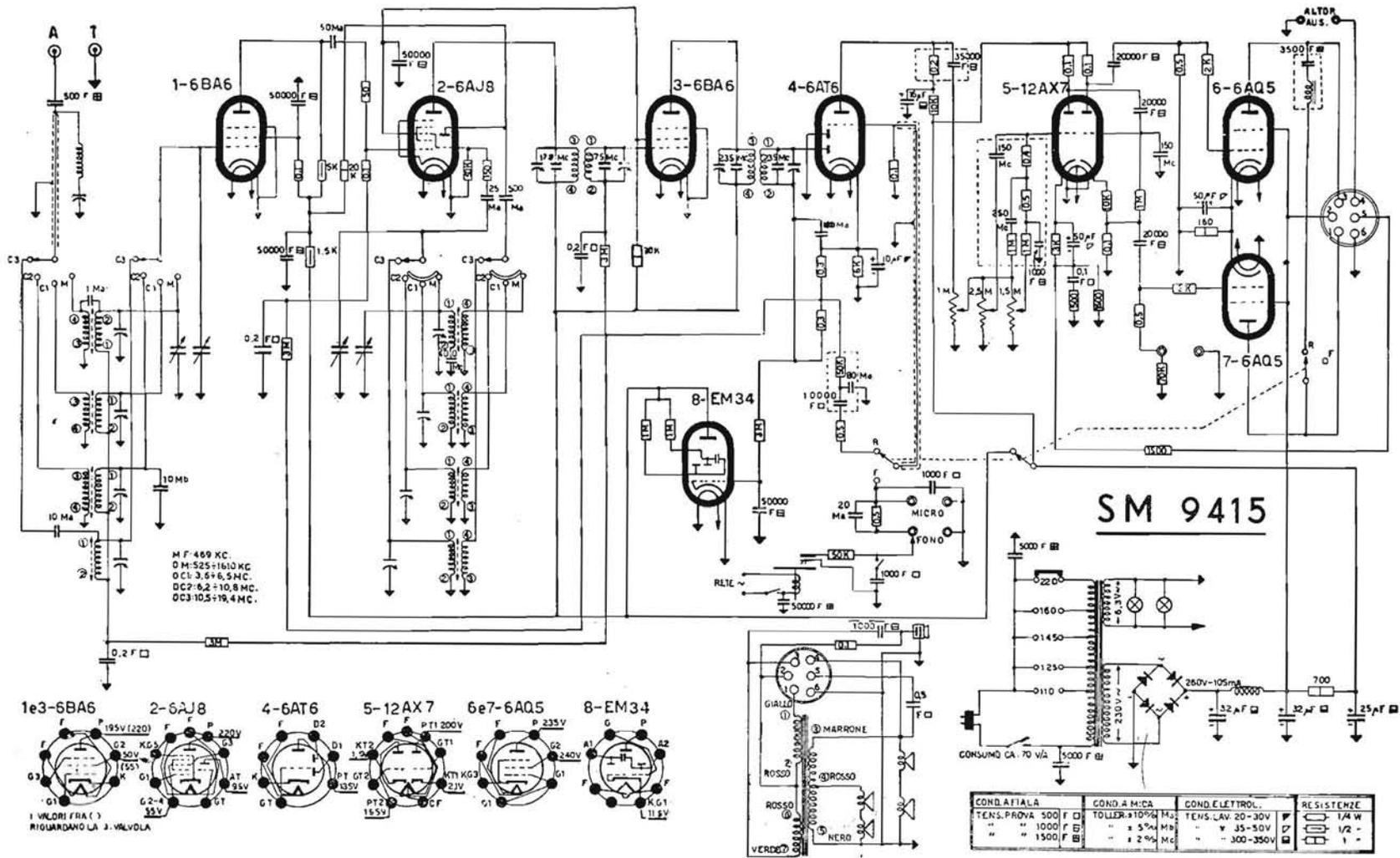
SIEMENS - Mod. SM 9415 Stereofonico. Apparecchio Hi-Fi, a quattro gamme: OM da 187 a 570 metri, OC da 16 a 28 metri e da 28 a 46 metri e OT da 45 a 80 metri. MF a 469 kc/s. Quattro altoparlanti magnetodinamici e uno elettrostatico. Potenza d'uscita indistorta 6 watt. Consumo 70 watt.
