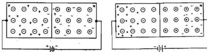
Fig. 1.7. - Distribuzione delle cariche elettriche elementari in due cristalli di germanio messi in contatto, e ai cui estremi è applicata una tensione elettrica.
