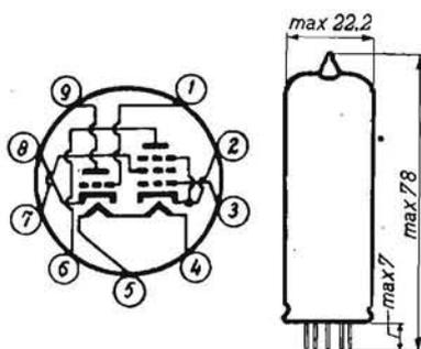
AMPLIFICATRICE BASSA FREQUENZA E AMPLIFICATRICE FINALE DI POTENZA. - Triodo e pentodo a catodi indipendenti. Il triodo è adatto per l'amplificazione di tensione del segnale BF e il pentodo per l'amplificazione finale, con resa d'uscita di 3,5 watt. Zoccolo noval.
