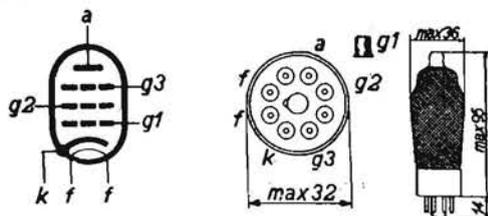
AMPLIFICATRICE ALTA E MEDIA FREQUENZA. - Pentodo a mu variabile per AF e MF, nonché per BF con accoppiamento a resistenza-capacità. Serie rossa 100 mA, zoccolo ad 8 piedini, griglia controllo sopra il bulbo di vetro. Per apparecchi con filamenti in serie.
