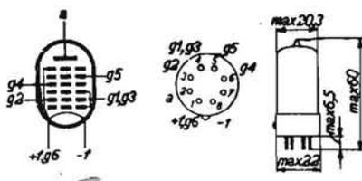
**CONVERTITRICE RIMLOCK.** - Per apparecchi a batteria. Accensione a 1,4 V e 50 mA. Tensioni: anodica 67,5 V, griglia 5, 67,5 V, griglia 2, 67,5 V, griglia 4 zero V. Correnti: placca 0,9 mA, griglie 1 e 3, 0,12 mA, griglia 2, 2,7 mA, griglia 5, 0,2 mA.
