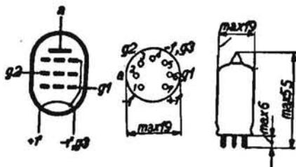
AMPLIFICATRICE AD ALTA FREQUENZA. - Valvola miniatura usata per apparecchi a pile. Accensione: 1,4 V e 50 mA. Placca: 90 V e 3,7 mA. Schermo: 67,5 V e 1,4 mA. Griglia: 0 V. Resistenza interna: 0,5 MΩ. Pendenza: 1 mA/V.
