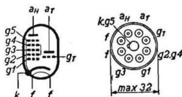
CONVERTITRICE DI FREQUENZA. - Per apparecchi senza trasformatore. Simile alla ECH3. Adatta anche per amplificazione alta o media frequenza. Serie «tutto vetro». Zoccolo nuovo tipo a piedini sottili.
