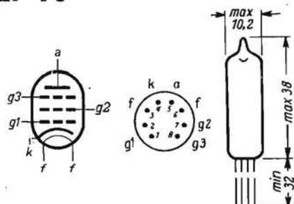
PENTODO SUBMINIATURA PER ALTA FREQUENZA. - È adatta a funzionare come amplificatrice di alta frequenza in ricevitori ultracompatiti. Poiché l'interdizione della corrente anodica avviene a -12 V di griglia, si presta a funzionare anche assai bene in circuiti limitatori di ampiezza e simili.
