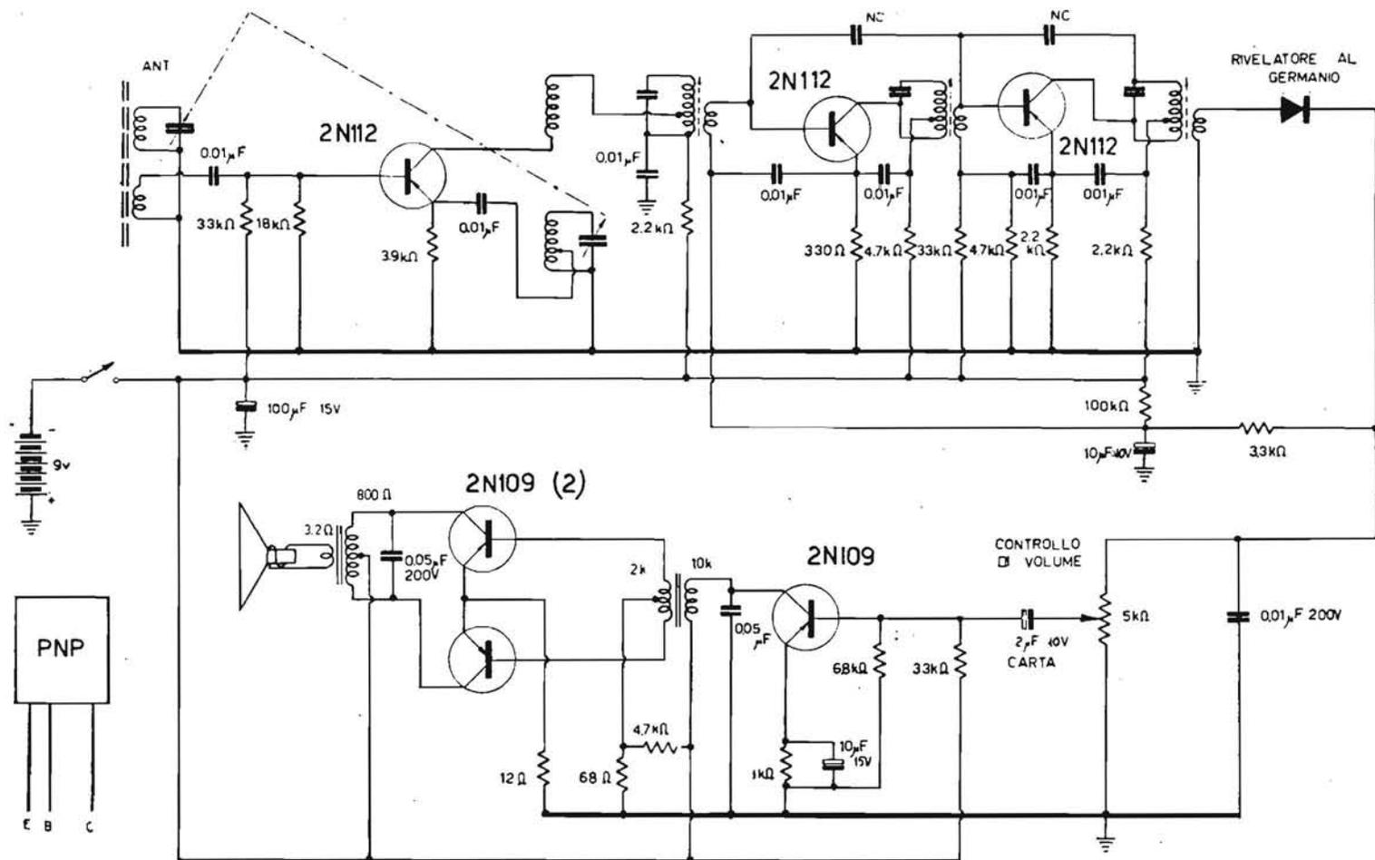
Fig. 2.15. - Schema di supereterodina a sei transistori, per apparecchio portatile.
