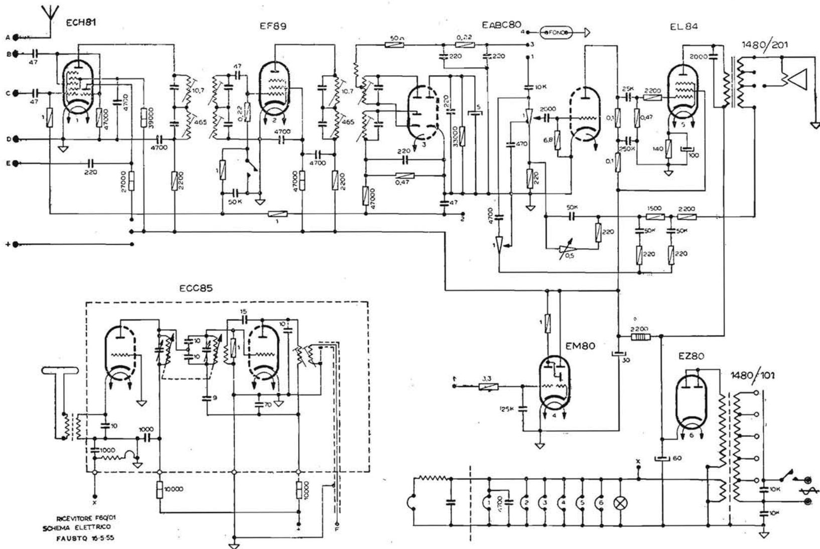
NOVA RADIO - Modd. F.60 e F.61 - Apparecchi a modulazione di ampiezza e di frequenza. Lo schema è del mod. F.60; il mod. F.61 differisce solo per avere 3 altoparlanti, con riproduzione 3D. Onde medie e onde corte/cortissime. Onde ultracorte a FM. Media frequenza AM a 465 kc/s, media frequenza FM a 10,7 Mc/s. Potenza d'uscita 5 watt.
