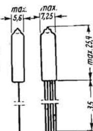
SUBMINIATURA A FILI USCENTI. Sostituisce la DF 67 in quanto richiede solo 10 anziché 13,3 mA di accensione; il filamento è realizzato in modo da consentire bassa microfonicità; la tensione di accensione è di 0,62 volt e può scendere sino a 0,45 volt, ma non superare i 0,62 volt. La resistenza ottima di griglia schermo è di 4,5 MΩ, quella di griglia controllo è di 10 MΩ. La resistenza di griglia della valvola che segue è di 5 MΩ.
