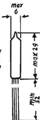
**DIODO RIVELATORE SUBMINIATURA.** - È adatto per l'impiego in circuiti rivelatori in apparecchi AM ed FM di tipo compatto. Ha caratteristiche elettriche simili alla noval EAA91. È adatto pure come rettificatrice CA.
