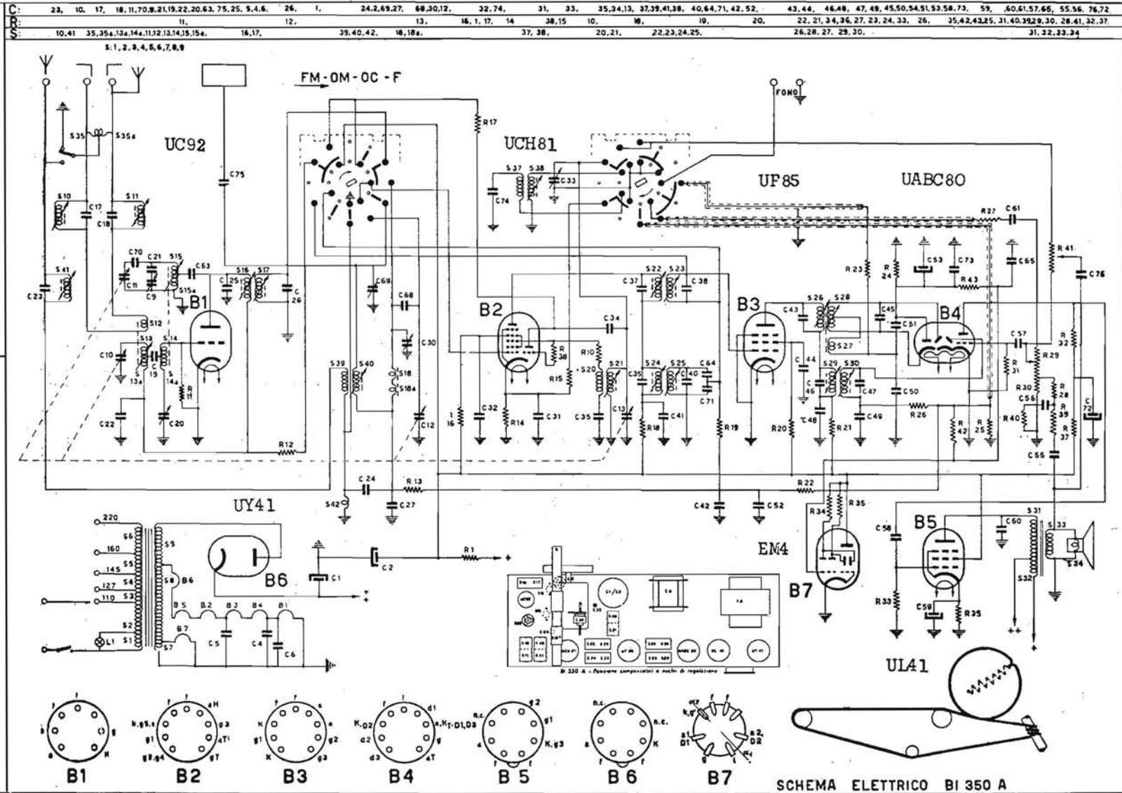
**PHILIPS RADIO - Mod. BI 350/A.** Apparecchio a modulazione d'ampiezza e di frequenza. Gamma onde medie, gamma onde corte e gamma onde ultracorte (FM). Media frequenza a 460 kc/s per AM e a 10,7 Mc/s per FM. Antenne incorporate a filo e ferroceptor. Potenza 4 watt, consumo 50 watt.
