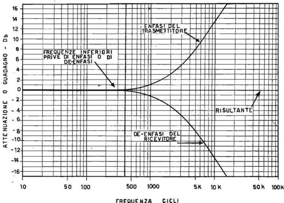
Fig. 3.5. - Grafico della enfasi al trasmettitore e della de-enfasi al ricevitore per lo standard di  $\pm 75$  chilocli.
