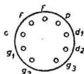
AMPLIFICATRICE ALTA E MEDIA FREQUENZA E RIVELATRICE. - Pentodo a pendenza variabile provvisto di due diodi per la rivelazione e il CAV. Dimensioni: 67 x 22. Zoccolo noval.
