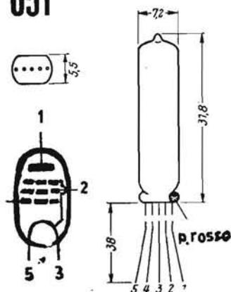
**SUBMINIATURA AMPLIFICATRICE FINALE.** - A parità di resa di uscita richiede 400 μA di placca anziché 500 μA richiesti dalla precedente valvola DL 67. La valvola DL 650 viene costruita per sostituire valvole della vecchia serie a 15 mA di accensione. La valvola DL 651 è il nuovo tipo a 10 mA d'accensione. La tensione di accensione è sempre di 0,625 volt. È del tipo a fili uscenti.
