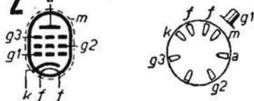
**AMPLIFICATRICE ALTA E MEDIA FREQUENZA** a pendenza variabile. Serie auto radio. Accensione: 6,3 V e 0,4 A. Placca: 250 V e 4,5 mA. Schermo: 100 V e 1,4 mA. Griglia: da - 2 a - 22 V.
