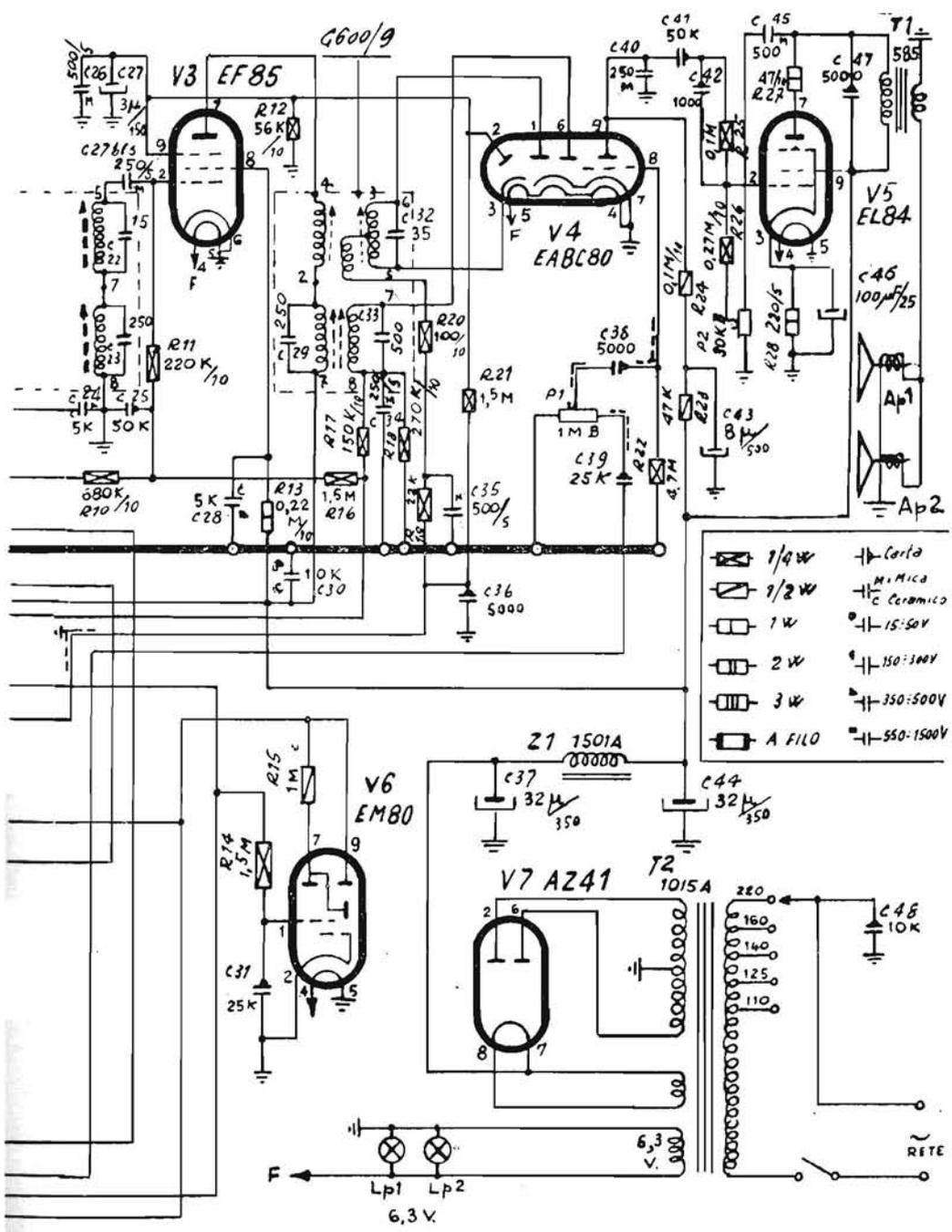
zione di ampiezza e di frequenza, con quattro gamme di ricezione, e FM a 10,7 Mc/s. Potenza d'uscita 4,5 watt, pot. assorbita 60 VA.
