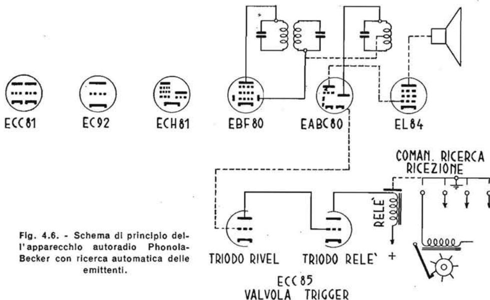
Fig. 4.6. - Schema di principio dell'apparecchio autoradio Phonola-Becker con ricerca automatica delle emittenti.
