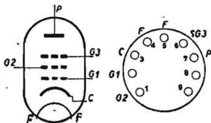
**PENTODO FINALE.** - È adatto per apparecchi di media potenza, e può seguire immediatamente il rivelatore, data l'elevatissima pendenza di 10,5 mA/V. Accensione 6,3 V e 0,71 A. Corrente di placca 36 mA. Tensione di placca 200 V. Tensione di griglia -3,5 V.
