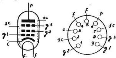
PENTODO AMPLIFICATORE DI TENSIONE. - È particolarmente adatto per lo stadio di entrata degli amplificatori BF ad alta sensibilità; i sostegni degli elettrodi sono molto brevi per evitarne la vibrazione e quindi l'effetto microfonico. È poco influenzata dalla tensione alternata d'accensione. Zoccolo noval.
