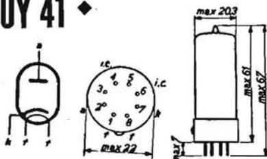
RETTIFICATRICE PER APPARECCHI SENZA TRASFORMATORE DI TENSIONE. - Appartiene alla serie rimlock. Accensione a 31 V e 0,1 A. Fornisce 90 mA con 250 V eff. di placca. Richiede una resistenza di protezione in serie alla placca di 60  $\Omega$  per reti a 160 V e di 160  $\Omega$  per reti a 220 V.
