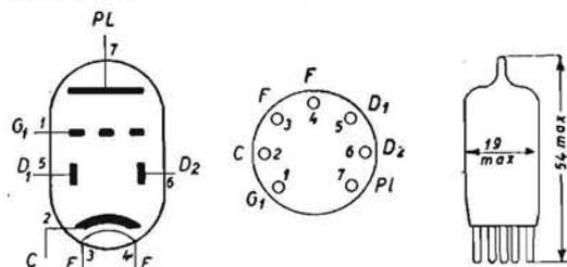
RIVELATRICE E AMPLIFICATRICE BF TIPO MINIATURA. - È caratterizzata da una elevata pendenza e da alto coefficiente di amplificazione. Accensione: 6,3 V e 0,3 A.
