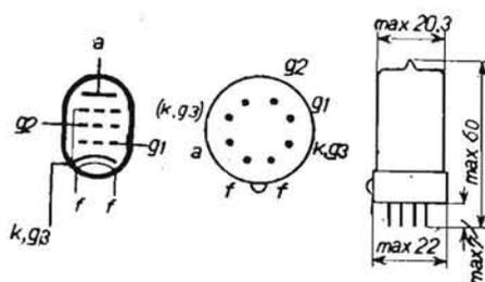
**FINALE DI PICCOLA POTENZA RIMLOCK.** - È un pentodo adatto per apparecchi compatti, di piccola potenza. Zoccolo rimlock ad 8 piedini.
