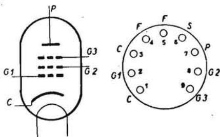
**AMPLIFICATRICE AF E MF.** - Pentodo di tipo noval tutto vetro. Accensione 6,3 V e 0,7 A. Tensione placca 170 V. Tensione schermo 170 V. Tensione griglia -2 V. Corrente placca 10 mA. Resistenza interna 400 KΩ.
