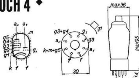
CONVERTITRICE TRIODO-EPTODO. - Adatta per apparecchi con filamenti in serie. Accensione a 20 V e 0,1 A. Stesse caratteristiche come la UCH 21 (v.). Zoccolo 8 piedini con guida.
