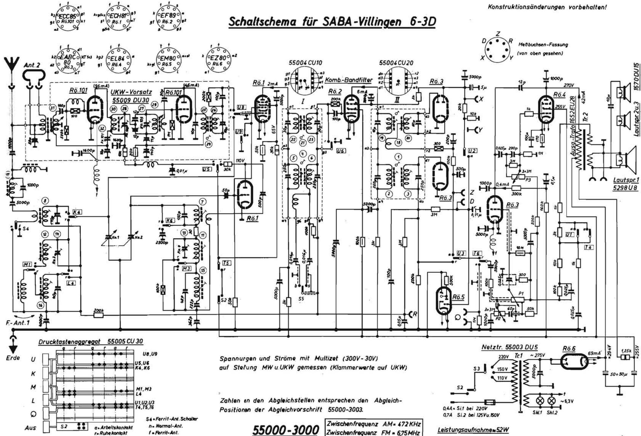
Spannungen und Ströme mit Multizet (300V-30V) auf Stellung MW u. UKW gemessen (Klammerwerte auf UKW)
