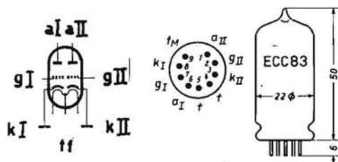
**DOPPIO TRIODO AD ALTA AMPLIFICAZIONE PER BF.** - È una valvola bene adatta per la preamplificazione di tensione in amplificatori ad audiofrequenza. È caratterizzata dall'alta amplificazione di tensione, circa 100 volte, e la ridottissima corrente anodica di circa 1 mA, per cui si presta bene in circuiti con controreazione, nonchè quale invertitrice di fase. Il filamento è con presa centrale e l'accensione è a 6,3 V e 0,3 A, oppure a 12,6 V e 0,15 A.
