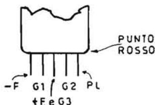
**SUBMINIATURA PER OTOFONI.** - Pentodo finale. Accensione: 1,25 V e 13,3 mA. Tensione di placca e schermo 22,5 V, corrente di placca 0,5 mA, corrente di schermo 0,1 mA. Pendenza 0,42 mA/V. Resa d'uscita 1,8 milliwatt.
