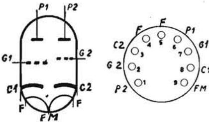
DOPPIO TRIODO. - Valvola noval a media amplificazione, con le stesse caratteristiche della ECC82, con accensione a 12,6 V e 0,15 A.
