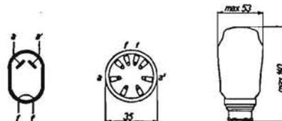
**RADDRIZZATRICE BIPLACCA A RISCALDAMENTO DIRETTO.** - Adatta per erogazione di corr. radd. relativ. elevate. Bulbo vetro a duomo. (Altezza max 112 mm, larghezza 51 mm)
