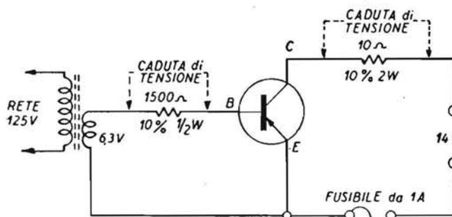
Fig. 2.30. - Circuito per la prova d'efficienza di transistor di potenza.
