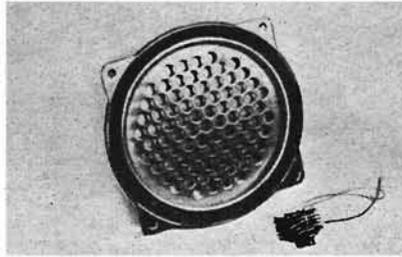
Fig. 3.34. - Aspetto esterno di altoparlante elettrostatico.
