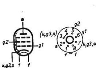
AMPLIFICATRICE ALTA E MEDIA FREQUENZA RIMLOCK. - Pentodo a  $\mu$  variabile adatto per amplificazione alta e media frequenza, nonchè per bassa frequenza con accopp. a resistenza-capacità. Zoccolo rimlock ad 8 piedini.
