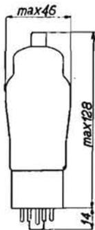
RIVELATRICE E FINALE RIMLOCK. - Pentodo finale con due diodi, adatta per apparecchi senza trasformatore di accensione, o comunque per apparecchi con valvole con filamenti in serie. Zoccolo rimlock ad 8 piedini.
