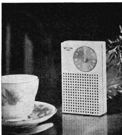
Fig. 2.17 - Aspetto dell'apparecchio a transistori Regency mod. TR-1.
