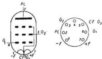
**FINALE PER APPARECCHI A PILE.** - Pentodo a riscaldamento diretto, serie miniatura, di media potenza, con resa d'uscita di 1,2 W. È provvisto di due filamenti. Accensione: 1,4 V e 0,1 A oppure 2,8 V a 50 mA.
