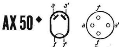
**RADDRIZZATRICE BIPLACCA AD ACCENSIONE DIRETTA, A GAS.** - Alla tensione alternativa massima di 500 volt per placca, consente l'erogazione massima di corrente raddrizzata di 250 milliampere. Accensione: 4 volt e 3,75 ampere.
