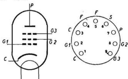
**PENTODO AMPLIFICATORE MF e AF.** - Adatto per connessione in serie dei filamenti. Zoccolo noval a 9 piedini. Accensione 21 V e 0,1 A.
