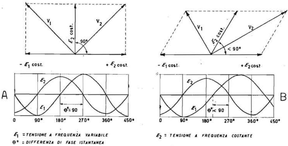
Fig. 3.15. - In A, la rivelazione di due tensioni alternative di ampiezza eguale e sfasate di  $90^\circ$ , dà luogo a due tensioni continue eguali e di segno opposto. A sinistra, la rivelazione delle suddette tensioni sfasate di un angolo diverso di  $90^\circ$ , dà luogo a due tensioni continue disuguali e di segno opposto. La differenza tra le due tensioni continue è proporzionale allo sfasamento delle due tensioni alternate.
