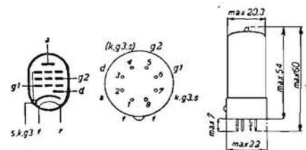
**AMPLIFICATRICE MEDIA FREQUENZA E RIVELATRICE RIMLOCK.** - Pentodo a mu variabile per amplif. alta e media frequenza, nonché bassa frequenza con accoppiam. a resistenza capacità. Adatta per piccoli apparecchi senza trasformatore di tensione. Zoccolo rimlock ad 8 piedini.
