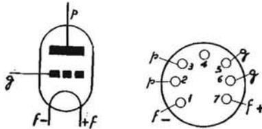
TRIODO PER ONDE ULTRACORTE. - È una miniatura adatta quale convertitrice in apparecchi a modulazione di frequenza. Accensione: 1,4 V e 50 mA. Placca: 90 V e 3 mA. Griglia: -3 V. Amplificazione: 12.
