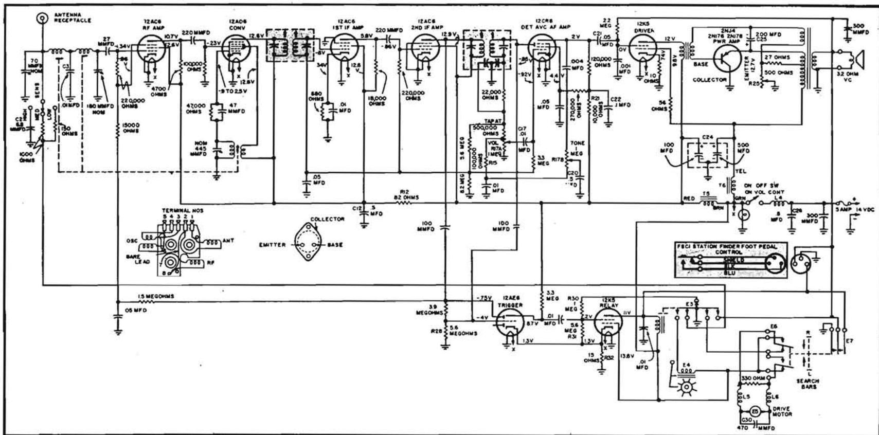
Fig. 4.12. - Schema elettrico complessivo di apparecchio autoradio con ricerca automatica delle emittenti, del tipo a motore. Lo stadio finale è transistorizzato, con resa d'uscita di 2,5 watt senza distorsione. Non vi è alimentatore anodico, essendo impiegate valvole a 12 volt di tensione anodica. (Motorola mod. 6TAS8).
