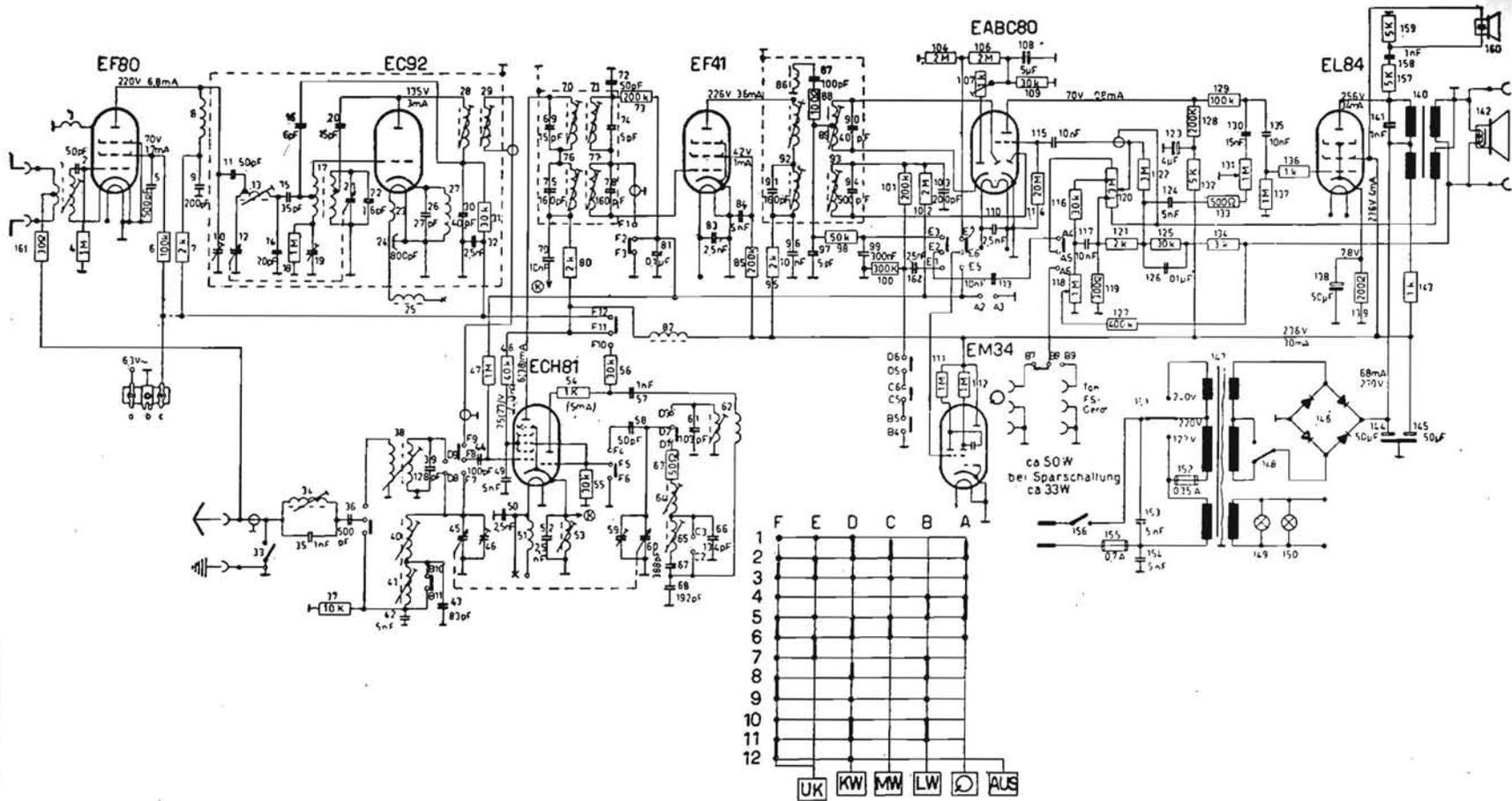
GRAETZ-SICART (Graetz Radio und Fernsehwerke, Altena) - Mod. Super 171 W. Apparecchio AM/FM, con tre gamme d'onda a modulazione d'ampiezza (lunghe, medie e corte) e una a modulazione di frequenza (onde ultracorte). Punti di allineamento: per OL 200 kc/s, per OM 600 e 1440 kc/s, per OC 7 Mc/s, per FM 88,5, 93 e 98 Mc/s. Ampia gamma sonora con due altoparlanti, di cui uno elettrostatico. Controlli dei toni bassi e alti. Potenza d'uscita indistorta 4 watt. (Produzione 1955).
