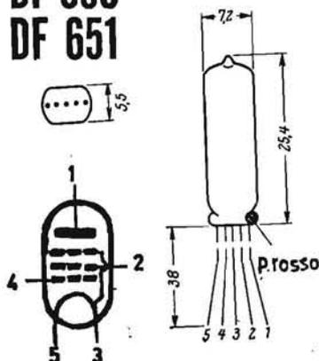
**SUBMINIATURA AMPLIFICATRICE A BASSA FREQUENZA.** - È caratterizzata da rumore ridottissimo; adatta quale amplificatrice di tensione BF in otofoni ed apparecchi radio tascabili; va impiegata insieme con il pentodo finale DL 650/651. La base è provvista di fili uscenti. La DF 650 consuma 15 mA di accensione, mentre la DF 651 ne consuma 10. La tensione di accensione è di 0,625 V per ambedue.
