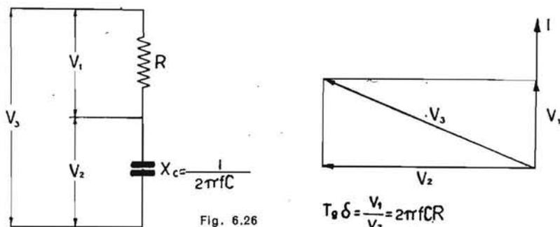
tensione ai capi del condensatore per effetto della sua reattanza. Il rapporto tra le due cadute di tensione, quella ai capi della resistenza e quella ai capi del condensatore costituisce l'angolo di perdita.
