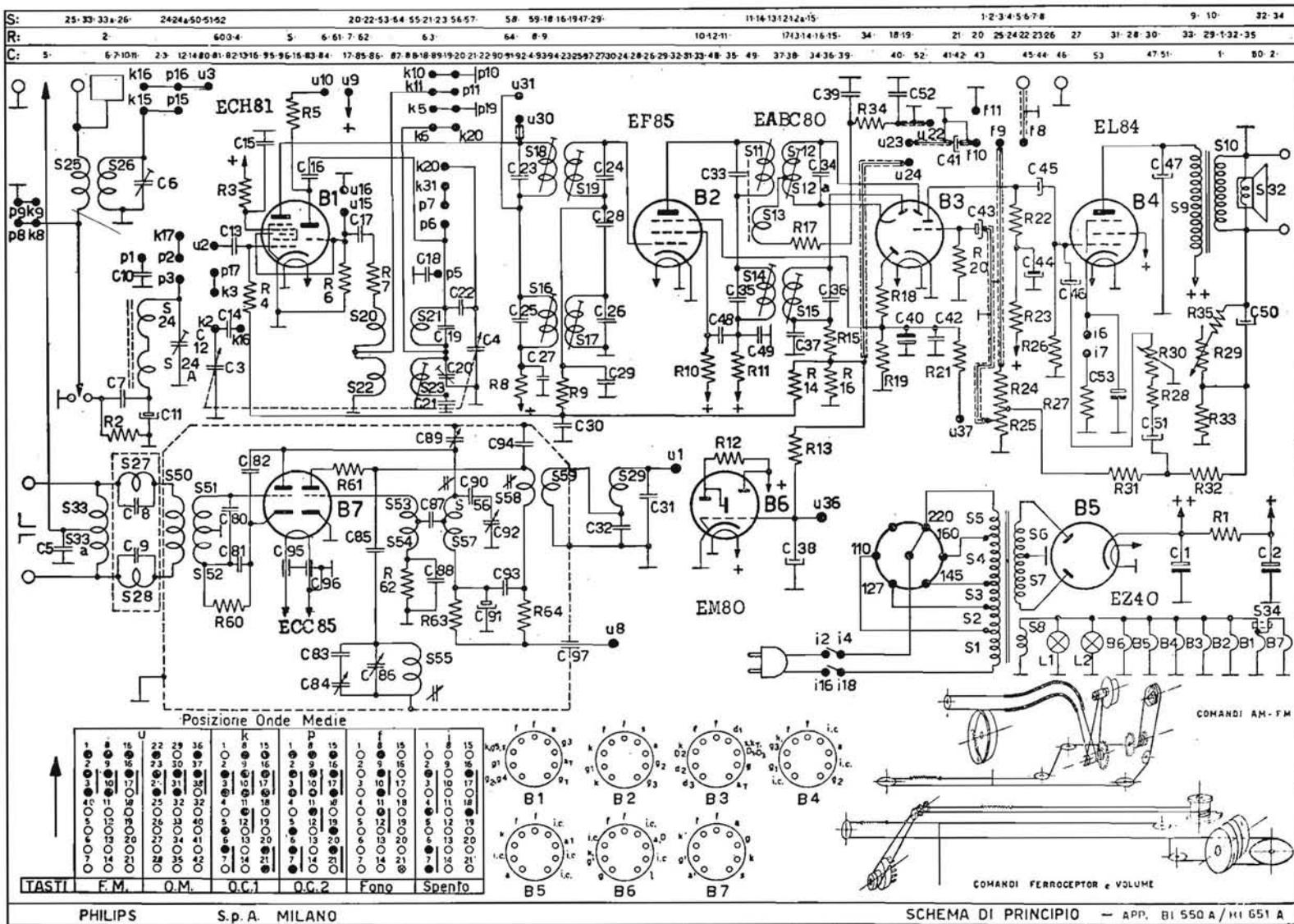
PHILIPS RADIO - Modd. BI 550/A e HI 651/A. A modulazione d'ampiezza e di frequenza, con una gamma onde medie, due gamme onde corte e una gamma onde ultracorte (FM). Media frequenza AM a 460 kc/s e FM a 10,7 Mc/s. Pot. d'uscita 4 watt; cons. 50 watt.
