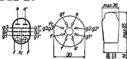
DOPPIO PENTODO D'USCITA PER APPARECCHI A PILE. - Accensione: 1,4 V e 200 mA o 2,8 V e 100 mA. Tensioni: placca e schermo 90 V, griglia - 5 V. Correnti: placca 6 mA, schermo 1,4 mA. Resistenza di carico 30.000 ohm. Potenza d'uscita 0,3 W, o 1,5 W con 120 V placca e schermo.
