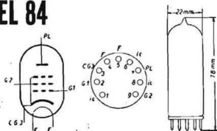
**PENTODO FINALE NOVAL.** - Appartiene alla serie delle valvole noval, ed è adatto per stadio finale di potenza, particolarmente per radiofonografi e per piccoli amplificatori. Zoccolo noval a nove piedini.
