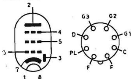
PENTODO A MU VARIABILE PER AMPLIF. AF/MF CON DIODO. - Tra la tensione allment. anodica e la griglia schermo, la resistenza è di 56.000 ohm.
