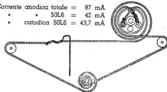
**RADIO MARELLI - Apparecchio AM/FM mod. 156.** Gamma onde medie da 515 a 1640 kc/s; onde corte da 3200 a 10100 kc/s e modulazione di frequenza da 87,5 a 100,5 Mc/s. MF/AM a 455 kc/s, MF/FM a 10,7 Mc/s. Potenza d'uscita 3 watt; consumo 68 watt. (Per allineamento e taratura v. istruzioni mod. 159, 163 e 164).
