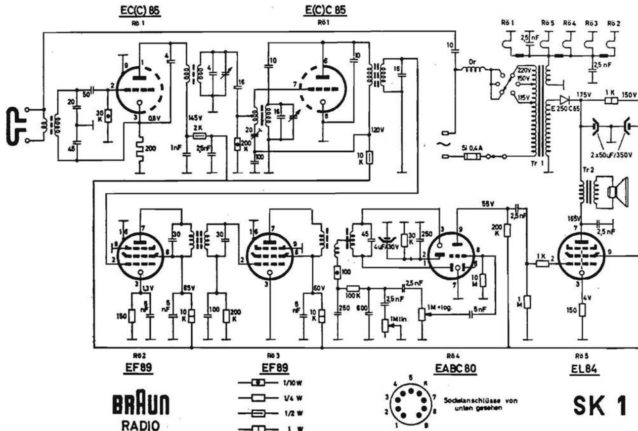
BRAUN (Max Braun Werke, Frankfurt/Main) - Mod. SK 1. Piccolo apparecchio a sola modulazione di frequenza, nella gamma da 87 a 100 Mc/s. Media frequenza a 10,7 Mc/s. Funziona con antenna-rete o con dipolo. Potenza d'uscita 2 watt. (Il mod. SK 2 è provvisto anche di OM/AM).
