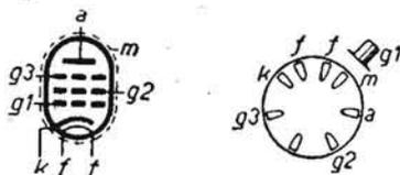
**PENTODO AMPLIFICATORE A PENDENZA FISSA** adatto per rivelazione a caratt. di placca e per amplificazione BF a resistenza. Serie auto radio. Accensione 6,3 V e 0,4 A. Placca; 250 V e 3 mA. Schermo 100 V e 0,9 mA. Griglia: - 2 V. Simile alla EF6.
