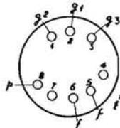
**PENTODO FINALE DA 8 WATT.** - È una valvola particolare della serie metallica ma con involucro di vetro. È presente in apparecchi importati dalla Germania. Accensione: 6,3 V e 1,2 A. Placca: 250 V e 72 mA. Schermo: 250 V. Griglia: -7 V. Resistenza interna: 17 k $\Omega$ . Pendenza: 15 mA/V. Resistenza di carico 3300 ohm.
