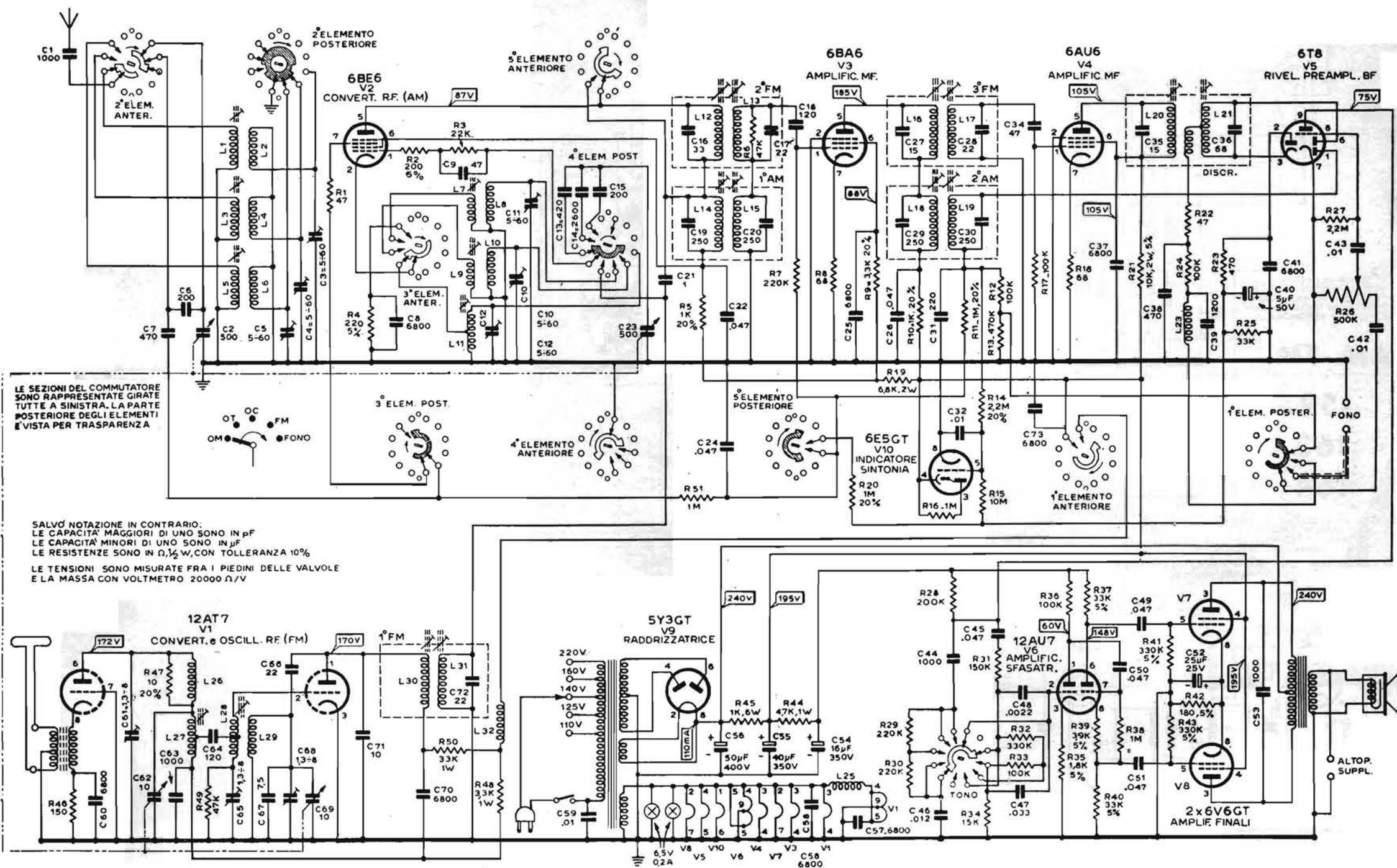
LE SEZIONI DEL COMMUTATORE SONO RAPPRESENTATE GIRATE TUTTE A SINISTRA. LA PARTE POSTERIORE DEGLI ELEMENTI E' VISTA PER TRASPARENZA
