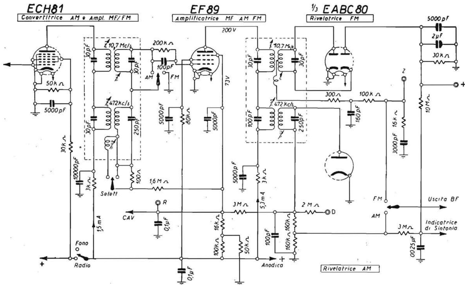
Fig. 3.20. - Schema degli stadi di rivelazione AM ed FM in apparecchio AM/FM di produzione commerciale. Il triodo della EABC 80 non è indicato in figura.
