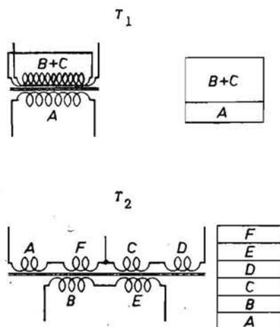
Fig. 1.33. - Caratteristiche degli avvolgimenti dell'apparecchio di fig. 1.32.
