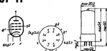
**AMPLIFICATRICE ALTA E MEDIA FREQUENZA.** - Pentodo a  $\mu$  variabile della serie rimlock, per apparecchi con filamenti in serie. Zoccolo rimlock ad 8 piedini.
