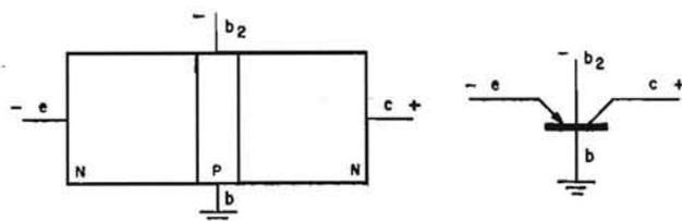
Fig. 2.33. - Disposizione degli elementi e simbolo dei transistori a tetrodo.
