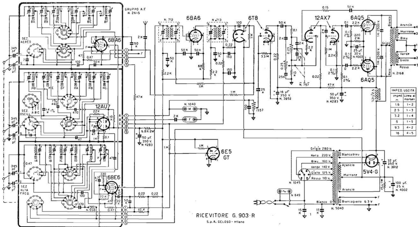
GELOSO - Mod. C. 903-R. Onde medie e cinque gamme onde corte. Amplificazione finale in controfase, con potenza d'uscita da 8 a 11 watt. Sensibilità d'antenna 2  $\mu$ V per 60 mw d'uscita. MF a 467 kc/s. Controlli alti e bassi.
