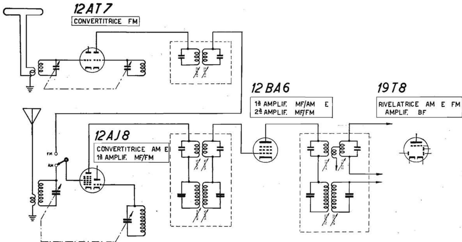
Fig. 3.10. - La conversione di frequenza e l'amplificazione a media frequenza nei ricevitori AM/FM.
