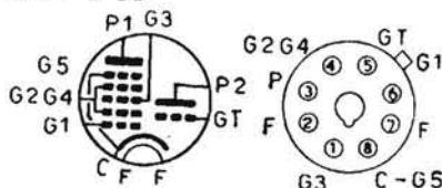
EPTODO E TRIODO CONVERTITORE DI FREQUENZA. - Ha le stesse caratteristiche elettriche della ECH4, dalla quale differisce per avere lo zoccolo octal americano al posto dello zoccolo octal europeo. Il bulbo di vetro è cilindrico.
