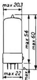
AMPLIFICATRICE MEDIA FREQUENZA E RIVELATRICE. - Valvola rimlock, pentodo a  $\mu$  variabile con diodo. Zoccolo 8 piedini.
