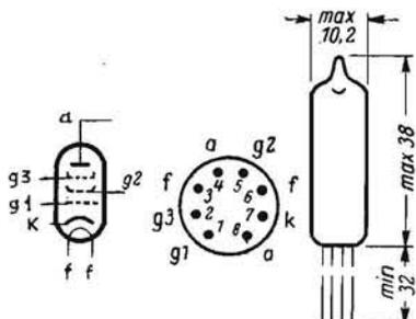
PENTODO SUBMINIATURA DI POTENZA. - Si presenta a funzionare sia come amplificatore AF che come amplificatore audio. Data l'elevata dissipazione di 1,4 watt e l'elevata pendenza, fornisce con facilità una potenza audio di circa 0,7 watt, per cui si presta ottimamente per lo stadio finale in apparecchi ultracompatti.
