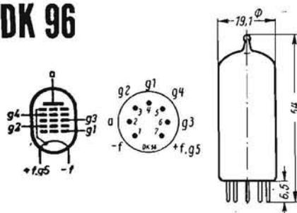
CONVERTITRICE DI FREQUENZA PER APPARECCHI A PILE. - Appartiene alle nuove serie di valvole con accensione a 25 mA e va usata insieme con la DF 96, DAF 96 e DL 96. È simile alla valvola DK 91 che viene da essa sostituita. Per frequenze superiori ai 20 Mc/s è da preferire la DK 92, dato che la DK 96 è caratterizzata da una minore pendenza.
