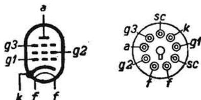
PENTODO AMPLIF. ALTA E MEDIA, particolarmente adatto per apparecchi ad onde ultracorte o di televisione. Accensione: 6,3 V e 0,3 A. Tensione placca e schermo 250 V, griglia -2 V. Corrente placca 10 mA, schermo 3 mA. Conduttanza mutua 6500 μA/V. Resistenza interna 1 MΩ. Zoccolo speciale a nove piedini.
