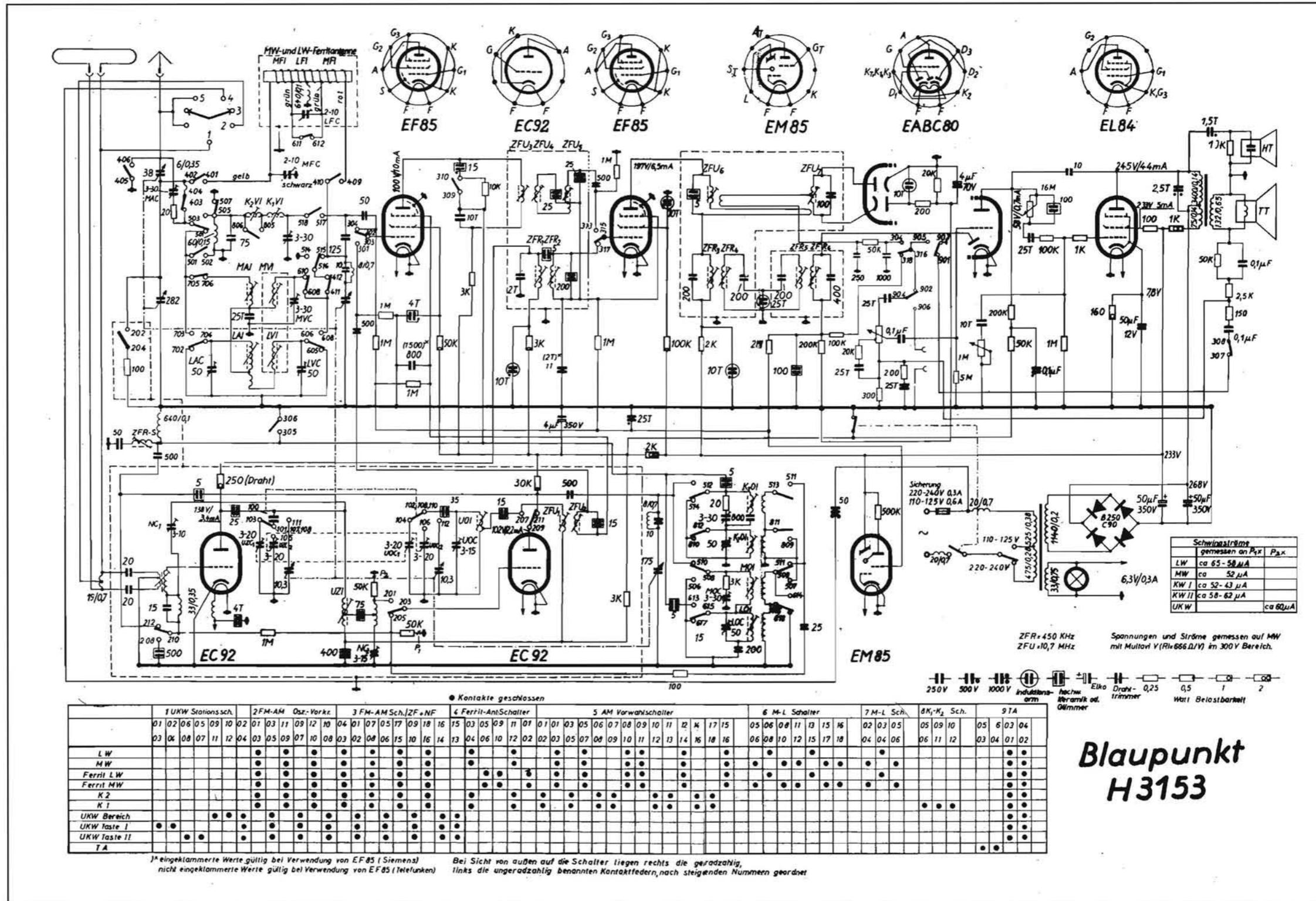
BLAUPUNKT (Blaupunkt Werke GmbH, Hildesheim) - Mod. Florenz. Apparecchio con quattro gamme d'onda AM e una gamma d'onda FM. Onde lunghe, medie e due corte. MF/AM a 450 kc/s, MF/FM a 10,7 Mc/s. Sensibilità di antenna: 3 μV per OM, 7 μV per OL, 15 μV per OC, e 1,5 μV per 25 kc/s FM. Due altoparlanti per la riproduzione dei toni alti e bassi. Potenza d'uscita 4 watt.
