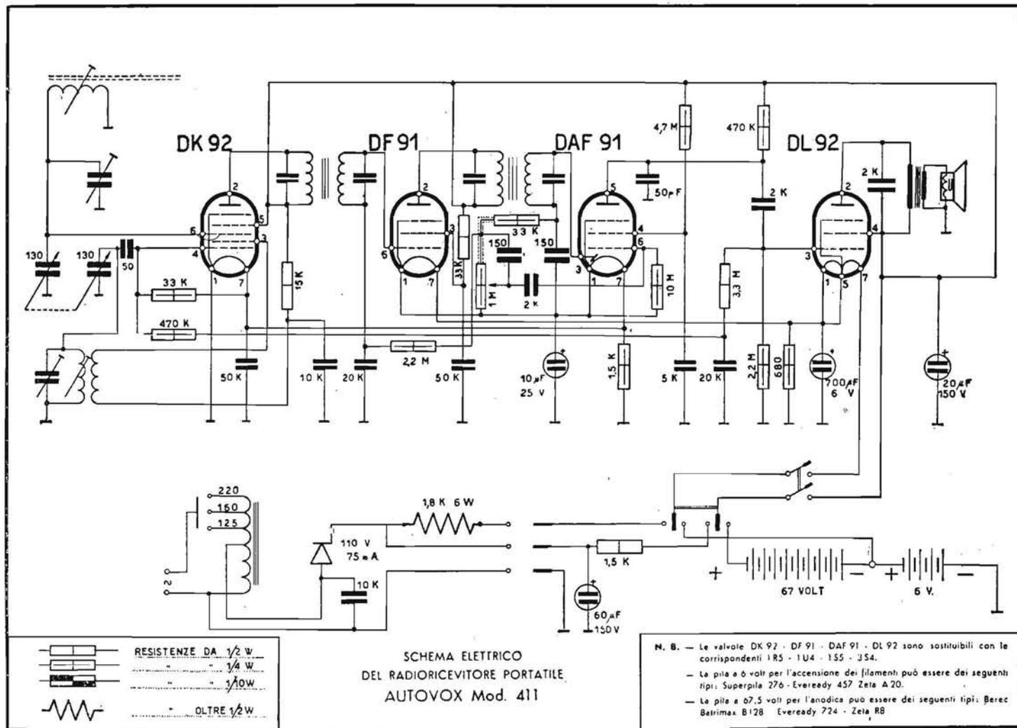
AUTOVOX - Mod. 411. Portatile alimentabile a pile e a corrente alternata. Gamma onde medie da 540 a 1600 kc/s. Dimensioni: 21×15×6 cm. Peso 1900 grammi. MF a 455 kc/s.
