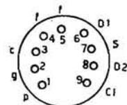
**DOPPIO DIODO TRIODO.** - È una valvola noval con le identiche caratteristiche della EBC 41 (v.) con la sola differenza dello zoccolo.
