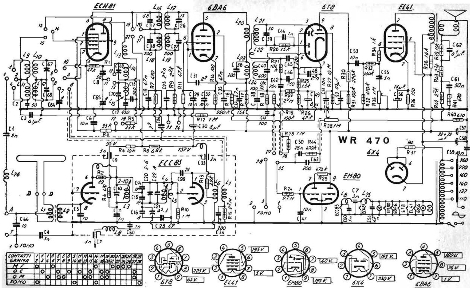
WATT RADIO - Mod. WR 470 Serie Anie, a modulazione d'ampiezza e di frequenza. Onde medie, onde corte e onde ultracorte (FM). Media frequenza AM a 470 kc/s e FM a 10,7 Mc/s. Potenza d'uscita indistorta 3 watt.
