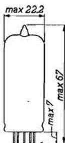
TRIODO AMPLIFICATORE BF E PENTODO FINALE. - È adatto per seguire la rivelatrice EQ 80 negli apparecchi FM, ed anche quale generatore di impulsi negli apparecchi TV.
