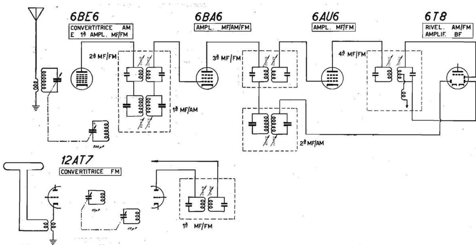
Fig. 3.9. - Circuiti di conversione di frequenza in apparecchi AM/FM.
