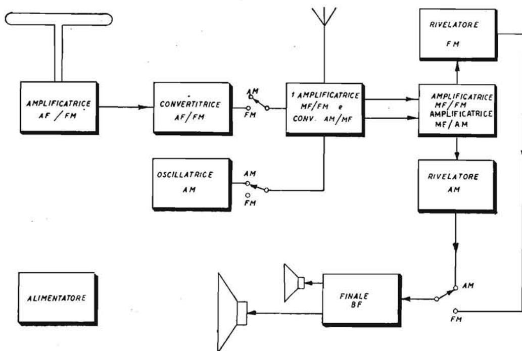
Fig. 3.8. - Schema a blocchi di apparecchio AM/FM
