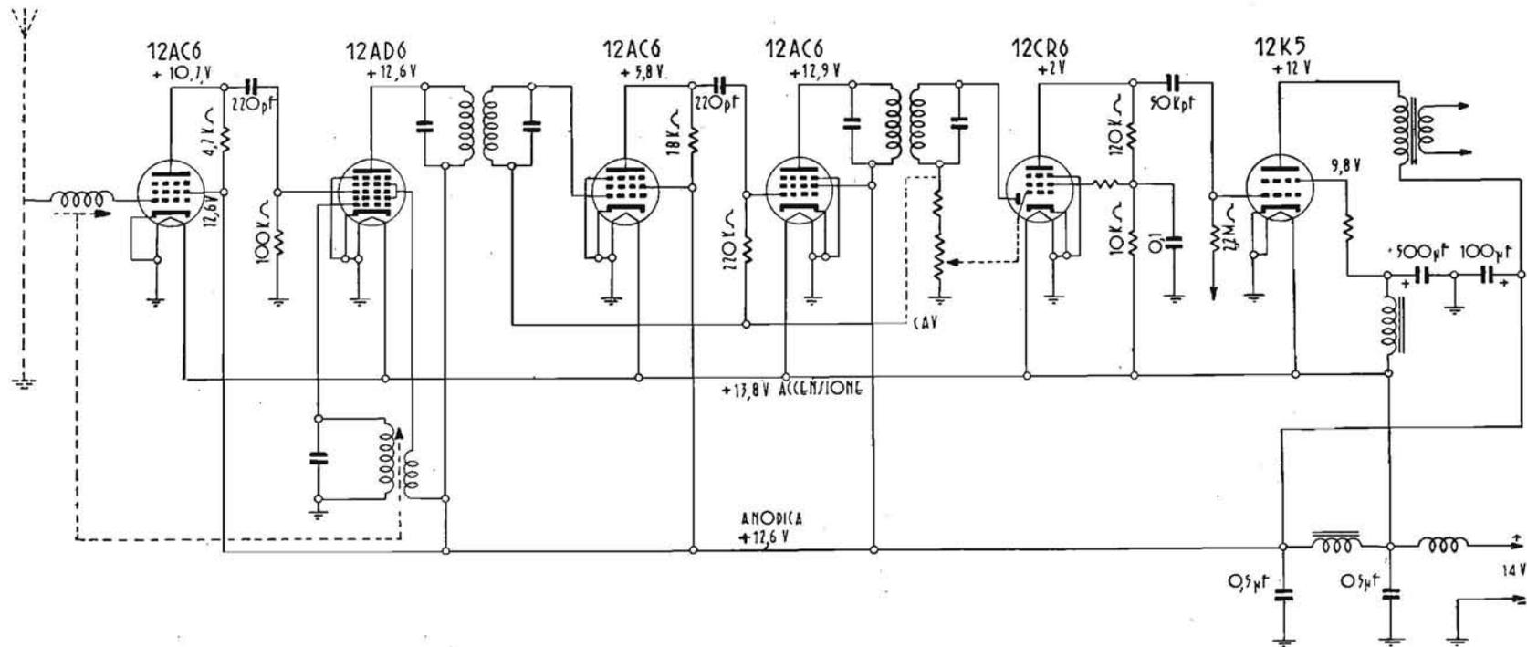
Fig. 4.14. - Esempio di impiego di valvole a 12 volt di tensione anodica in apparecchi radio. La tensione d'accensione è superiore a quella della batteria d'accumulatori (di 12 volt) per la presenza dei condensatori-serbatoio.
