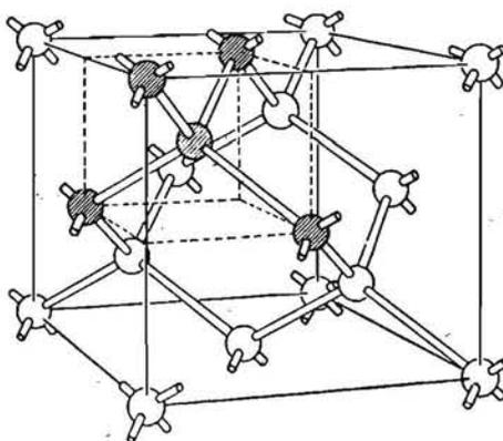
Fig. 1.4. - Gli atomi di germanio sono tenuti insieme nel complesso cristallino dai quattro elettroni periferici, detti elettroni di valenza.
