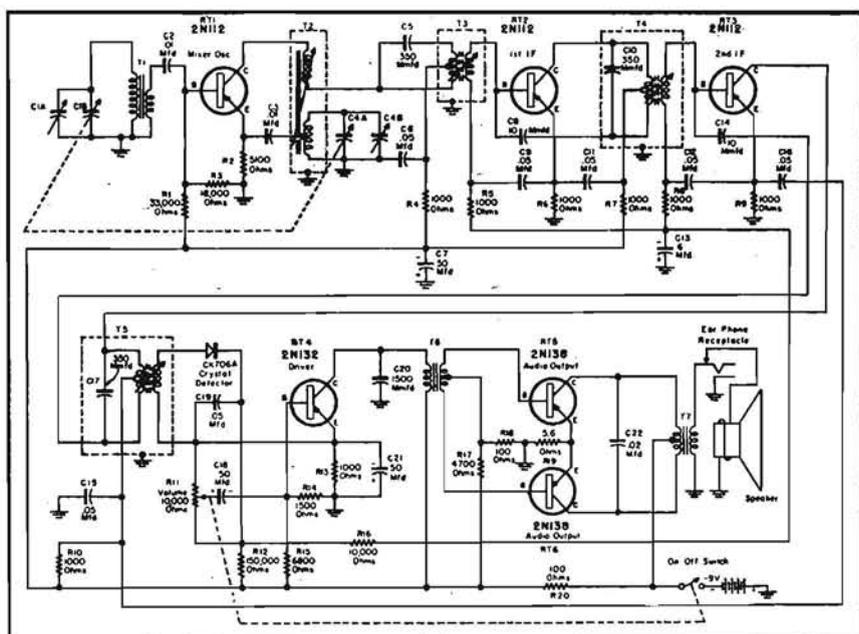
Fig. 2.21. - Schema del portatile Raytheon mod. T-150.
