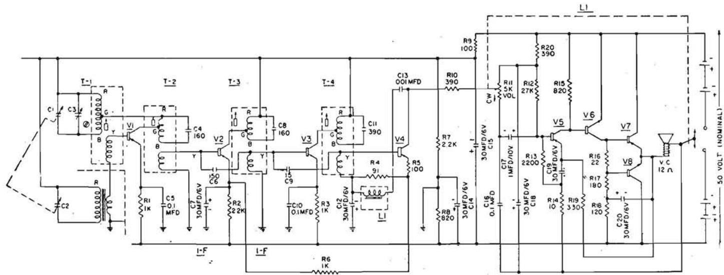
Fig. 2.27. - Schema originale di apparecchio a transistori, di tipo sperimentale, della Radio Corporation of America. I due transistori finali sono collegati in modo da eliminare i due trasformatori d'entrata e d'uscita.
