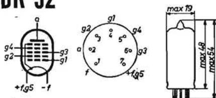
**PENTAGRIGLIA MINIATURA PER APPARECCHI PORTATILI A PILE.** - È un eptodo adatto per lo stadio di conversione di frequenza per apparecchi portatili a pile o a pile-rete (B/CA/CC). Valvola miniatura a 7 piedini. Accensione 1,4 V e 0,05 A.
