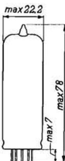
PENTODO AMPLIFICATORE PER VIDEO-FREQUENZA. - Adatto per apparecchi TV, nei quali viene usato quale pilota per il tubo catodico di visione. Accensione: 15 V e 0,3 A. Tensioni placca e schermo 200 V, corrente placca 36 mA, corrente schermo 5 mA.
