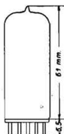
CONVERTITRICE PER ULTRAFREQ. - Triodo eptodo di tipo noval. Bene adatto per apparecchi FM, per ricevitori ad OC e per televisori. Le caratteristiche sono quelle stesse della valvola ECH81, dalla quale differisce per l'accensione, che è di 19 V e 0,1 A.
