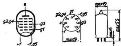
**CONVERTITRICE PENTAGRIGLIA MINIATURA.** - Per apparecchi a batteria, Accensione a 1,4 V e 50 mA. Tensione anodica e griglie 2 e 4, a 45 V, griglia 3, da 0 a -9 V, corrente anodica 0,7 mA, griglie 2 e 4, 1,9 mA. Tensione anodica e griglie 2 e 4 a 67,5 V, griglia 3 da 0 a -14 V, corrente anodica 1,4 mA, griglie 2 e 4, 3,2 mA.
