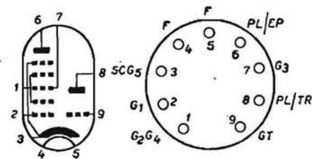
CONVERTITRICE PER APPARECCHI FM. - Triodo-eptodo di tipo novale. La terza griglia dell'eptodo è indipendente dalla griglia del triodo. Accensione: 6,3 V e 0,3 A.
