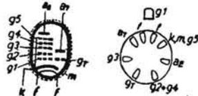
**CONVERTITRICE DI FREQUENZA** con penta-griglia modulatrice e triodo oscillatore. È simile alla ECH3 con in più la quinta griglia (soppressore). Griglia schermo a tensione variabile con una resistenza in serie di 24.000 ohm.
