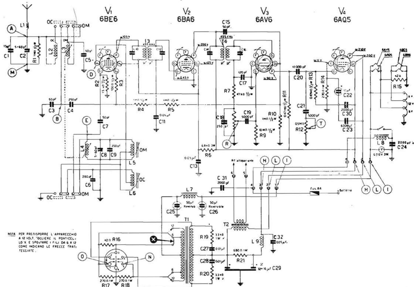
AUTOVOX - Mod. RA 49 seconda serie. Onde medie da 520 a 1600 kc/s e onde corte da 5,95 a 6,3 Mc/s. Media frequenza a 455 kc/s. Potenza d'uscita 1,5 watt. Consumo totale: circa 2,5 A a 12 V e circa 4,7 A a 6 V.
