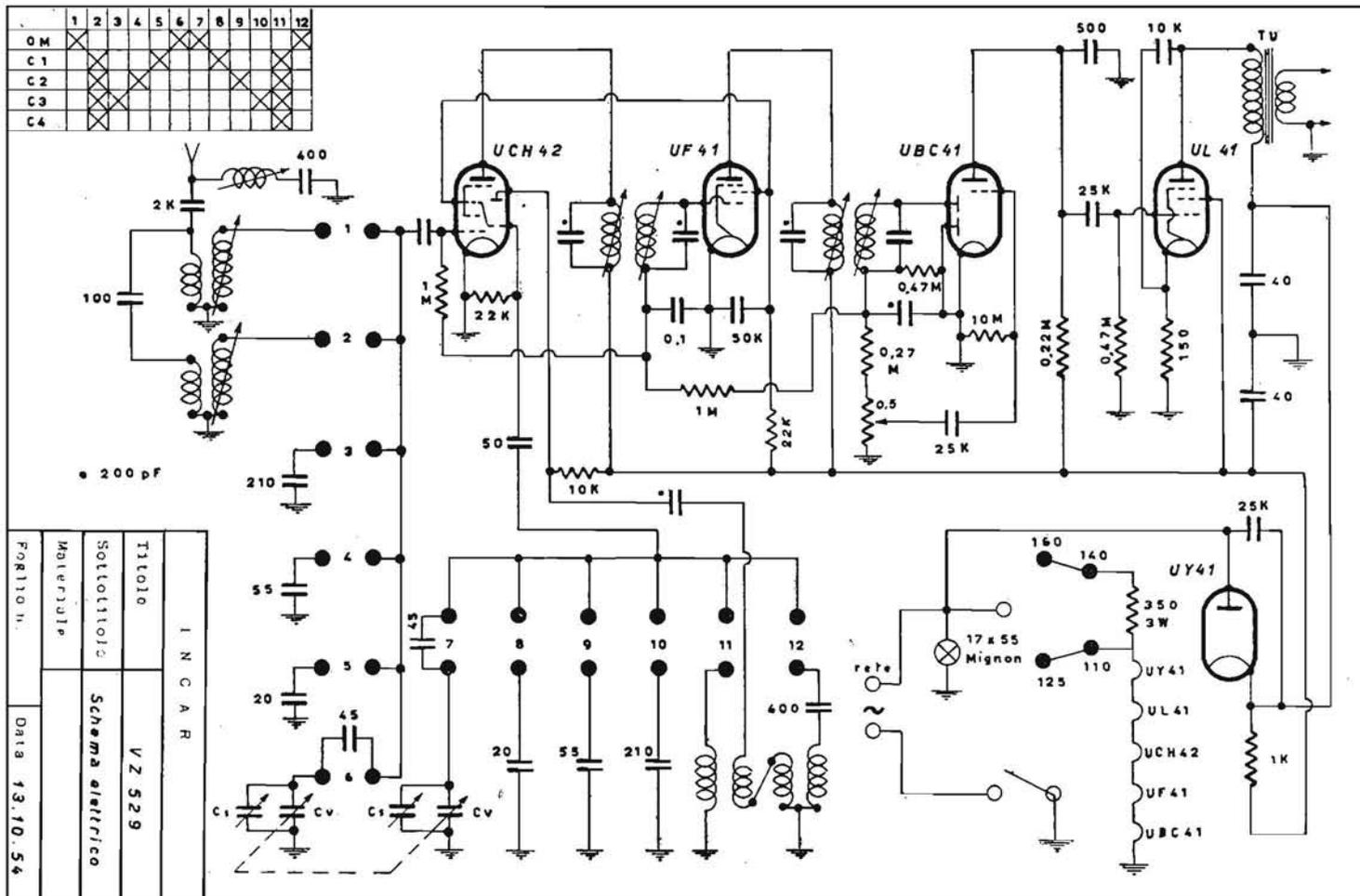
INGCAR - Mod. VZ 529 - Ricevitore a onde medie con quattro bande allargate ad onde corte. Potenza d'uscita 3 watt. Consumo 50 watt.
