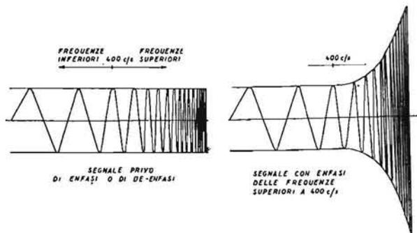
Fig. 3.4. - A sinistra, gamme di frequenze acustiche di ampiezza costante; a destra stessa gamma di frequenze acustiche di ampiezza crescente a partire da 400 cicli per effetto di enfasi.
