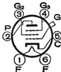
Il pentodo va usato come rivelatore, come amplificatore le griglie n. 2 e 3 vanno collegate alla placca.
