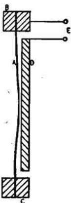
Fig. 3.33. - Schema di principio dell'altoparlante elettrostatico.
