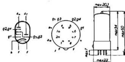
CONVERTITRICE TRIODO-ESODO. - Adatta per apparecchi con filamenti in serie, senza trasformatore di tensione. Zoccolo rimlock ad 8 piedini.
