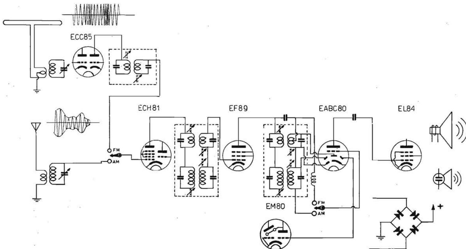
Fig. 3.26. - Funzione delle varie valvole di un tipico apparecchio AM/FM di medie dimensioni.
