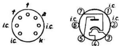
RETTIFICATRICE PER PICCOLI APPARECCHI. - Diodo a riscaldamento indiretto adatto per l'alimentazione degli apparecchi funzionanti con tensioni anodiche ridotte. Zoccolo miniatura a sette piedini.
