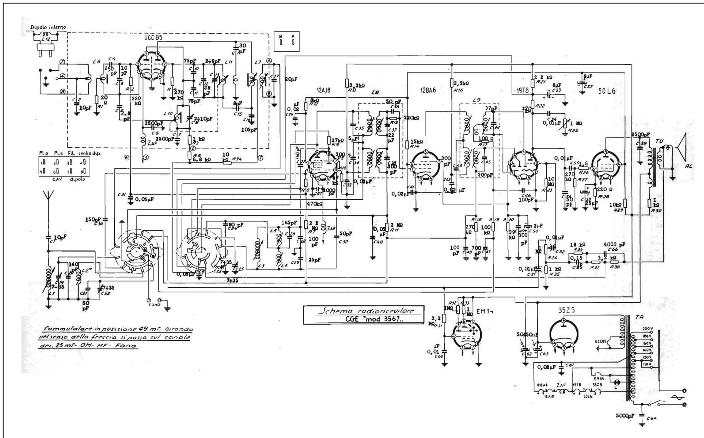
COMPAGNIA GENERALE DI ELETTRICITA' - Mod. CGE 3567. Apparecchio a modulazione di ampiezza e di frequenza. Una gamma onde medie, due gamme onde corte, a 25 e a 49 metri, e una gamma onde ultracorte (FM). Media frequenza AM a 468 kc/s e media frequenza FM a 10,7 Mc/s. Potenza d'uscita 3 watt.
