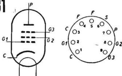
AMPLIFICATRICE PER AF E MF. - Pentodo noval, tutto vetro ad alta pendenza. Accensione 6,3 V e 0,3 A. Tensione placca 170 V. Tensione schermo 170 V. Tensione griglia -2 V. Corrente placca 10 mA. Resistenza interna 400 kΩ.
