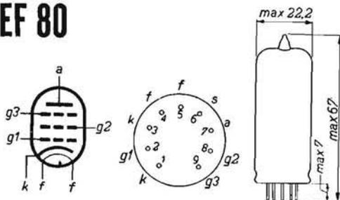
CONVERTITRICE DI FREQUENZA E AMPLIFICATRICE ALTA E MEDIA FREQUENZA. - Per apparecchi FM e TV. A larga banda passante.
