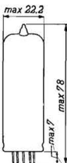
DIODO RETTIFICATORE. - Adatto per apparecchi TV, come diodo damper in apparecchi televisori. Accensione: 19 V e 0,3 A. Erogazione: 180 mA CC a 240 volt.
