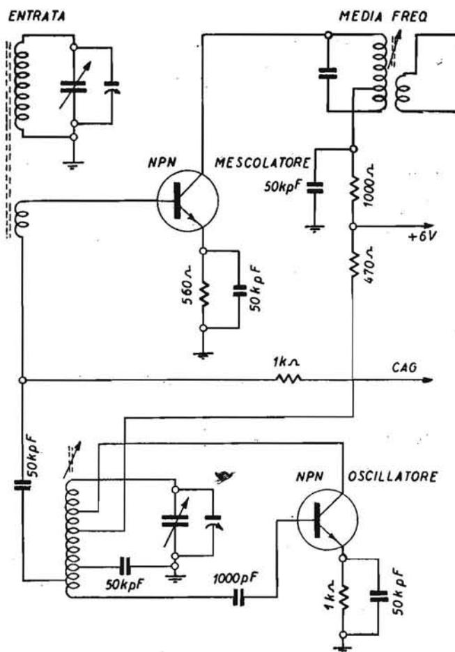
Fig. 2.5. - Conversione di frequenza con due transistori NPN.
