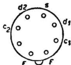
**DOPPIO DIODO RIVELATORE FM.** - Consiste di due diodi a catodi separati. Accensione: 6,3 e 0,3 A. Placca 330 V e 9 mA.
