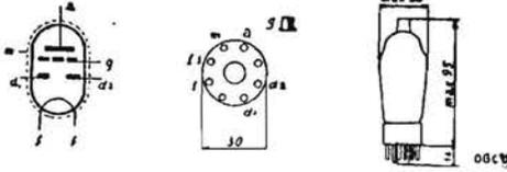
DOPPIO DIODO TRIODO PER APPARECCHI A PILE. - Accensione: 1,4 V e 50 mA. Tensione placca 90 V, griglia - 0,5 V. Corrente placca 1,4 mA. Amplificazione 25. Pendenza 0,85 mA/V. Resistenza interna 30 000 ohm. È possibile applicare alla placca 120 V.
