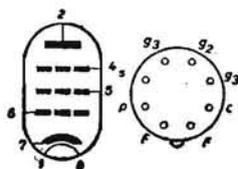
AMPLIFICATRICE A BANDA LARGA PER TELEVISORI. - Pentodo a mu variabile per AF e MF video. Accensione: 6,3 V e 0,3 A. Con 250 V di placca e di schermo, richiede -2 V di griglia, o resistenza catodica di 105Ω; la corrente di placca è di 15 mA e quella di schermo di 3,5 mA. Tipo noval.
