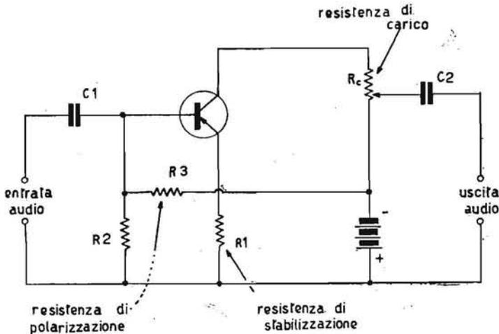
Fig. 1.19. - Un partitore di tensione costituito dalle resistenze R2 e R3 provvede alla corrente di polarizzazione del transistor.
