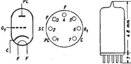
TRIODO PER ULTRAFREQUENZE. - È caratterizzato dalla alta pendenza, ed è bene adatto nello stadio di entrata e in quello d'oscillatore degli apparecchi FM, nonché nei televisori. Le caratteristiche sono quelle stesse della valvola EC92, ad eccezione della tensione e corrente di accensione, che sono rispettivamente di 9,5 V e 0,1 A.
