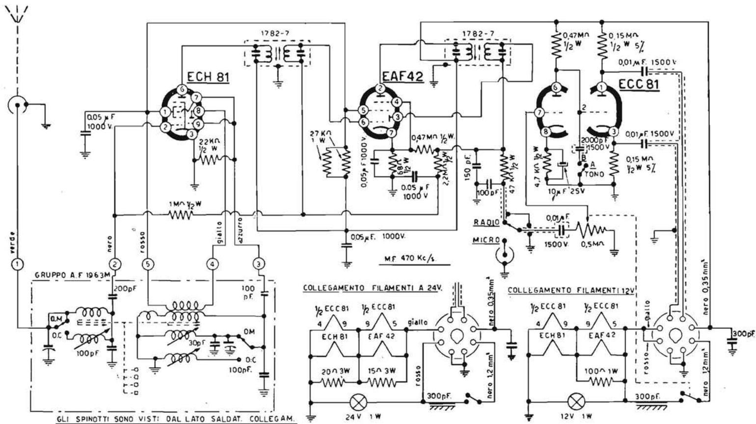
GALLO-CONDOR - Sintonizzatore per autoradio mod. 2114/T Pullman 10. Onde medie e corte con commutazione a tiranti. Media frequenza a 470 kc/s. Lo schema dell'alimentatore e dello stadio finale è riportato a parte.
