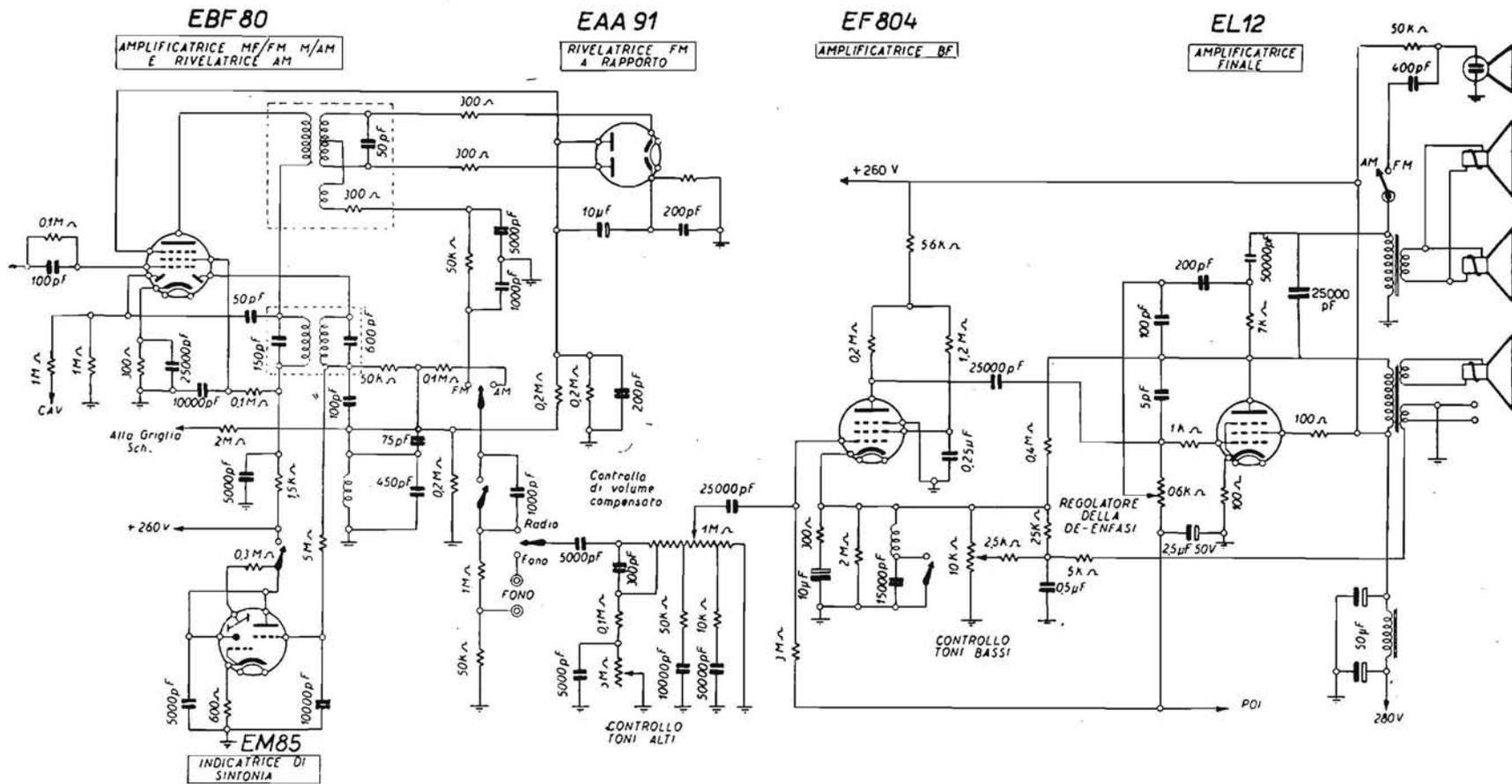
Fig. 3.37. - Schema degli stadi di rivelazione ed amplificazione ad audiofrequenza, di apparecchio AM/FM del tipo 3D.
