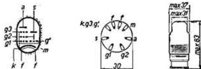
INDICATRICI DI SINTONIA e amplificatrice BF. Contiene un pentodo amplif. BF e una targhetta fluorescente a raggi catodici, con doppia zona d'ombra. È adatta per seguire la EBF2.
