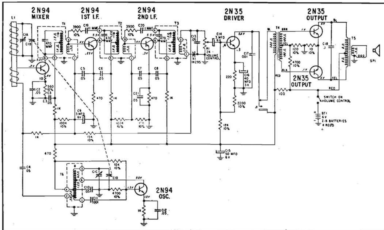
Fig. 2.26. - Schema originale dell'apparecchio a transistori Zenith mod. 500. I sei transistori sono tutti del tipo NPN.
