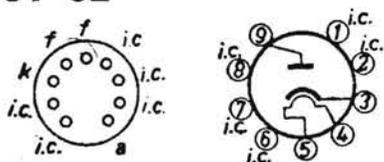
RETTIFICATRICE A 65 V E 0,1 A. - Diodo a riscaldamento indiretto con caratteristiche identiche alla EY82, dalla quale differisce per l'accensione a 65 V e 0,1 A. Zoccolo noval.
