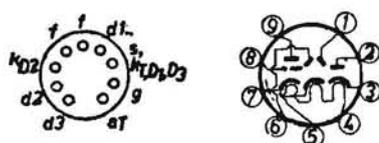
**RIVELATRICE AM/FM E AMPLIFICATRICE BF.** - Triodo con tre diodi, due dei quali per la rivelazione FM ed il terzo per la rivelazione AM e per il CAV. Zoccolo octal.
