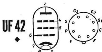
**AMPLIFICATRICE PER TELEVISORI.** - Pentodo rimlock adatto per ultrafrequenza. Accensione: 21 V e 0,1 A funziona con 170 V di placca e di schermo, -2 V di griglia, 12,3 mA di corrente di placca e schermo, pendenza 8,5 mA/V.
