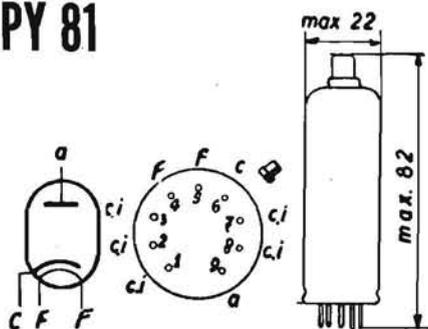
**DIODO DAMPER PER TELEVISORI.** - Diode smorzatore degli impulsi di tensione di fine riga, ed economizzatore. È simile alla PY80. Accensione: 17 V e 300 mA. Funziona con 220 V massimi di tensione d'alimentazione e 600 V di tensione rettificata. Corrente anodica massima 150 mA. Corrente di picco massima 450 mA.
