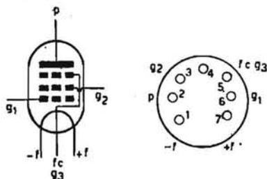
**PENTODO FINALE DI USO GENERALE AF, BF.** - È una valvola miniatura adatta sia per l'amplificazione in alta frequenza (50 Mc/s) con resa di uscita di 1,2 W nonchè per l'amplificazione di bassa frequenza in stadio finale con resa di uscita di 0,7 watt. Accensione: 1,4 V e 0,2 ampere.
