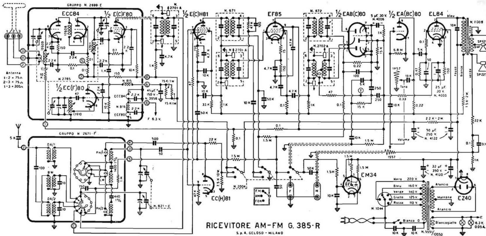
GELOSO - Mod. AM/FM G. 385/R. Ricevitore a modulazione d'ampiezza e di frequenza, con una gamma OM da 190 a 580 m, e due gamme OC da 43 a 130 m e da 14 a 43 m, nonchè FM da 87,5 a 101 Mc/s. MF/AM a 467 kc/s MF/FM a 10,7 Mc/s. Potenza d'uscita 3,5 watt. Consumo 70 watt.
