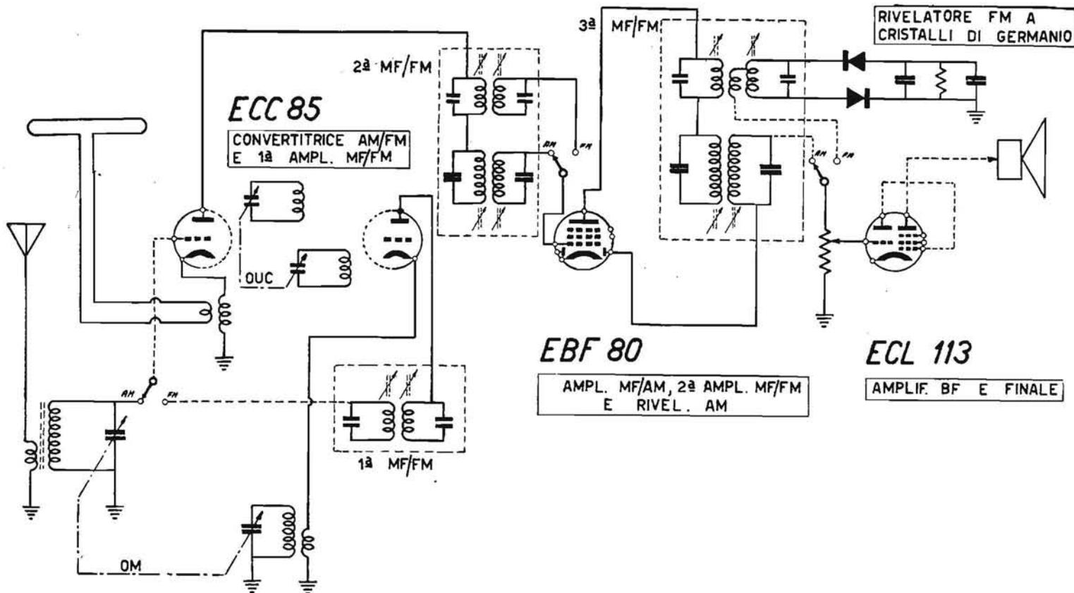
Fig. 3.28. - Schema di apparecchio AM/FM a tre sole valvole, con una coppia di cristalli al germanio (Schema Grundig).
