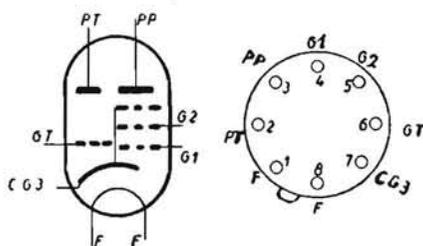
**TRIODO PENTODO DI USO GENERALE.** - Adatto per amplificazione BF con triodo e di potenza come pentodo. Sostituisce vantaggiosamente la vecchia valvola WE13. Rimlock a otto piedini.
