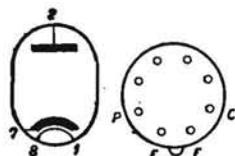
RETTIFICATRICE CON ACCENSIONE A 31 V E 0,1 A. - Adatta per apparecchi in continua/alternata, con 110 V massimi di placca, fornisce 100 mA di corrente rettificata.
