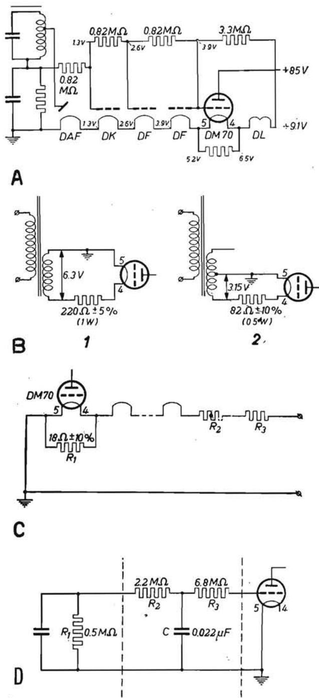
Fig. 8.3. - Esempi di collegamento della DM70.
