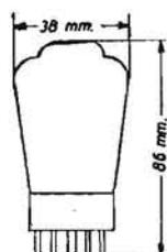
RADDRIZZATRICE BIPLACCA. - È del tipo a riscaldamento indiretto, con accensione a 5 V e 1,9 A. Consente di erogare 250 mA da 300 sino a 450 V. È adatta, oltre che per apparecchi radio, anche per amplificatori. È simile alla 5Z3. Dimensioni: altezza mass. 86 mm; diam. 38 mm.
