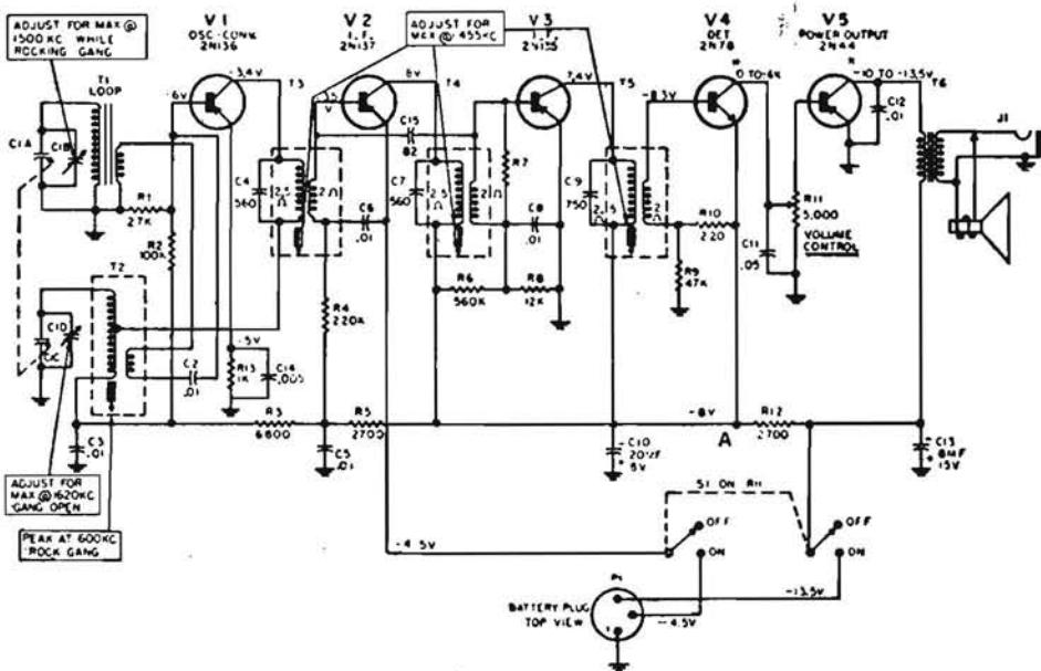
Fig. 2.18. - Schema originale dell'apparecchio General Electric mod. 675.
