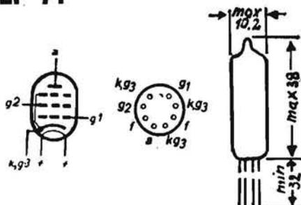
PENTODO SUBMINIATURA PER ALTA FREQUENZA A PENDENZA VARIABILE. - È caratterizzata da elevata pendenza e si presta bene alle frequenze molto elevate. Data la piccolezza del suo involucro è adatta in costruzioni ultracompatte.
