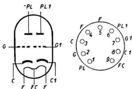
**DOPPIO TRIODO NOVAL PER BF.** - È adatto quale invertitore di fase e amplificatore di tensione in radiofonografi ed in amplificatori BF. È simile alla valvola americana 12AU7. Zoccolo noval a nove piedini. È provvisto di filamento con presa al centro. Accensione: 12,6 V e 0,15 A oppure 6,3 V e 0,3 A.
