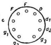
AMPLIFICATRICE ALTA E MEDIA FREQUENZA, E RIVELATRICE. - Pentodo a pendenza variabile, provvisto di due diodi, uno per la rivelazione e l'altro per il CAV. Dimensioni 67 x 22. Zoccolo noval.
