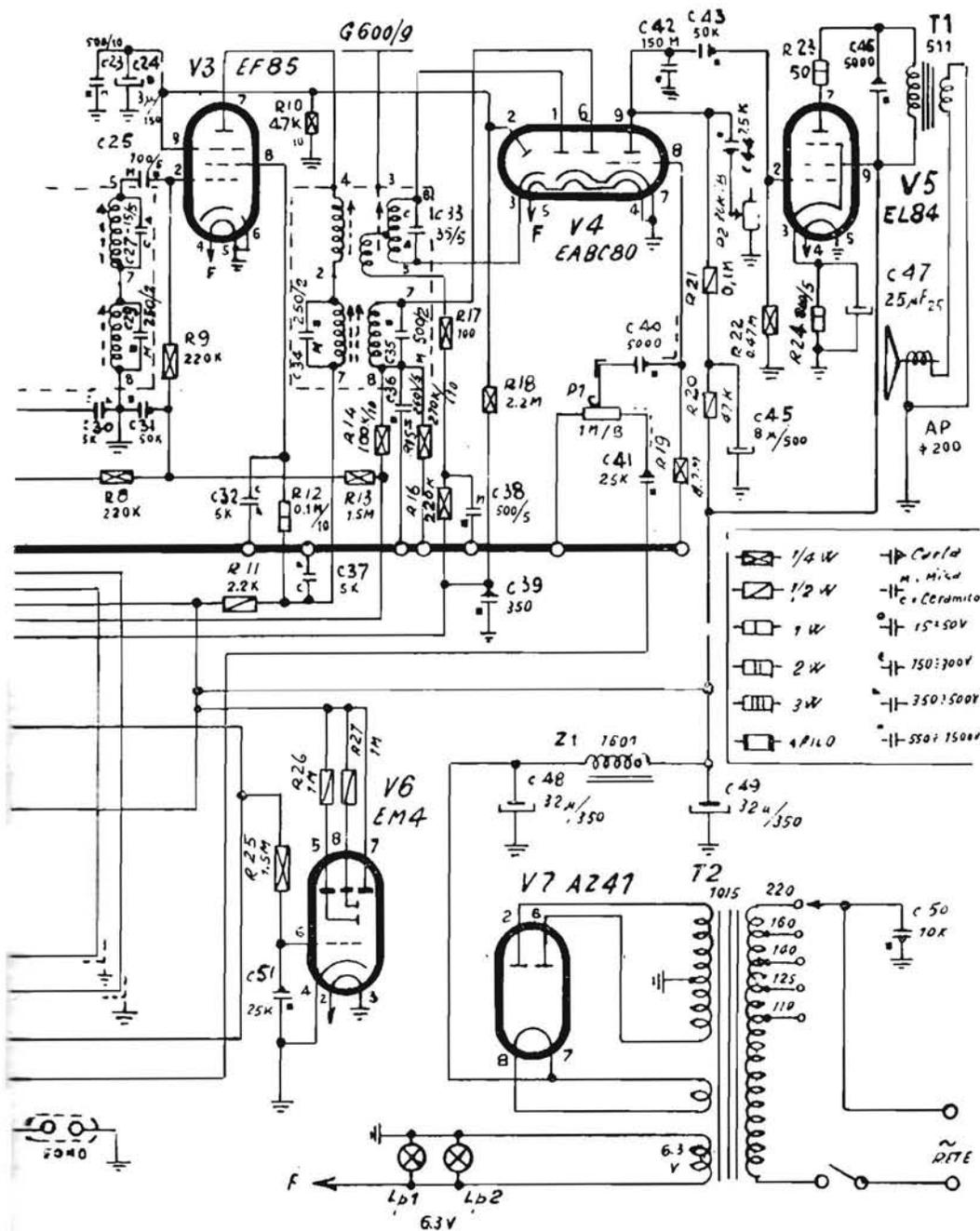
me di ampiezza e di frequenza, con cinque gamme di ricezione, FM a 10,7 Mc/s. Potenza d'uscita 4,5 watt e potenza assorbita 60 VA.
