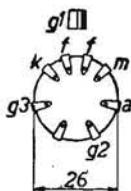
PENTODO AMPLIFICATORE A PENDENZA FISSA per rivelazione di placca e amplif. BF a resistenza.
