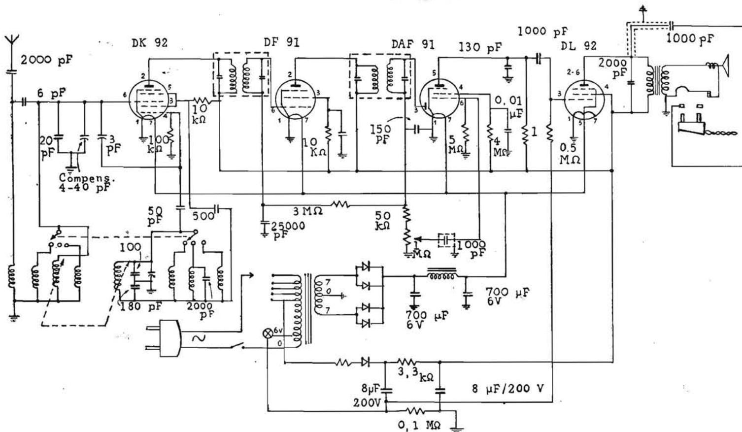
ALLOCCIO BACCHINI - Mod. Junior III per sola alimentazione in corrente alternata. Onde medie e due gamme onde corte.
