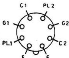
DOPPIO TRIODO AMPLIFICATORE DI TENSIONE BF. - Può venir usato come finale con resistenza di carico di 15.000 ohm, dissipazione 1,5 watt, resa d'uscita 0,28 watt.
