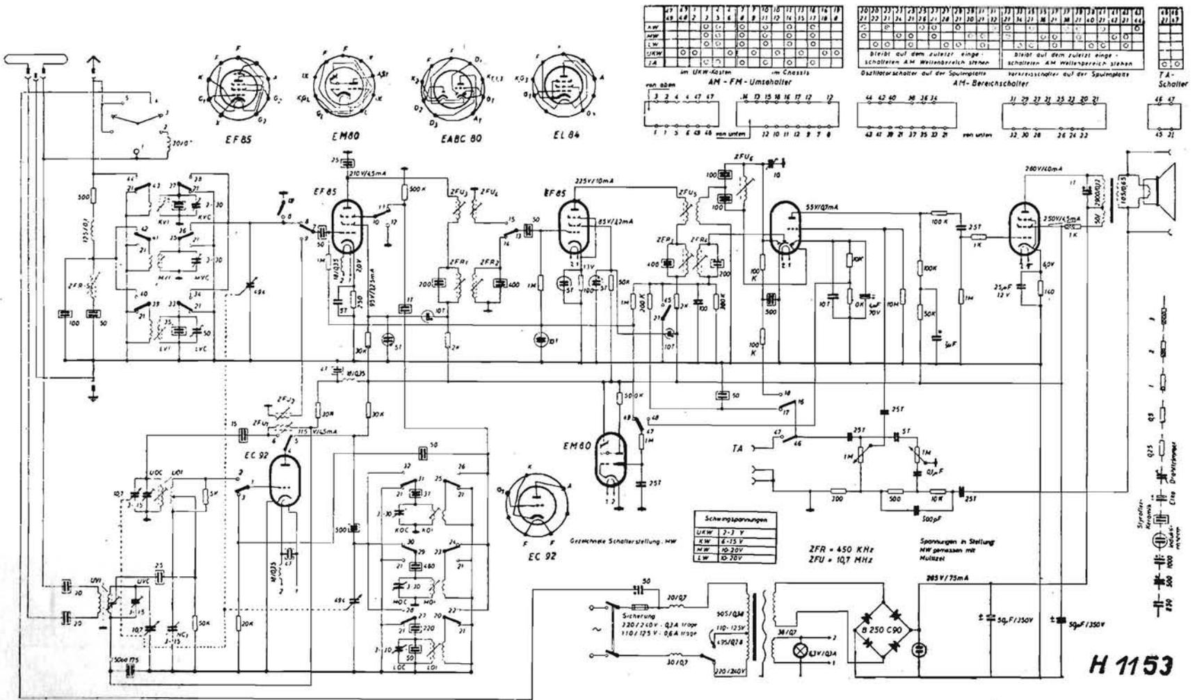
BLAUPUNKT (Blaupunkt Werke GmbH, Hildesheim) - Mod. Roma. Apparecchio AM/FM. Onde lunghe da 160 a 350 kc/s, onde medie da 546 a 1500 kc/s, onde corte da 6,05 a 15,4 Mc/s, onde ultracorte (FM) da 87 a 100 Mc/s. MF/AM a 450 kc/s, MF/FM a 10,7 Mc/s. Sensibilità d'antenna 10  $\mu$ V per OM, 15  $\mu$ V per OL e 20  $\mu$ V per OC. Potenza d'uscita 3 watt indistorti.
