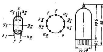
**DOPPIO TRIODO PER ULTRAFREQUENZE.** - È adatto quale convertitore di frequenza in apparecchi FM. Differisce dalla valvola precedente ECC 81 per una più accurata schermatura tra le due sezioni. La valvola si presta bene nello stadio di amplificazione AF, in circuito cascode per televisori. Le due sezioni sono identiche. Accensione: 6,3 V e 0,435 A.
