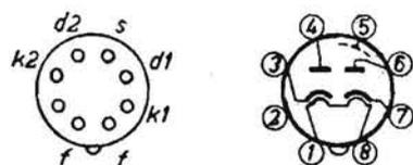
RIVELATRICE AM o FM: - Doppio diodo a catodi separati adatto per la rivelazione AM o FM in apparecchi radio di elevata qualità. Zoccolo rimlock.
