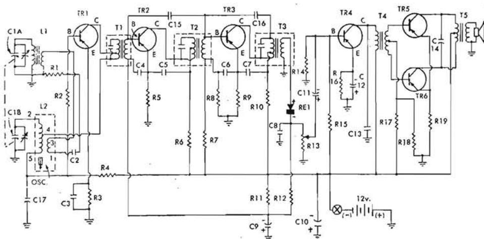
Fig. 2.23. - Schema originale dell'apparecchio a transistori Lafayette Radio.
