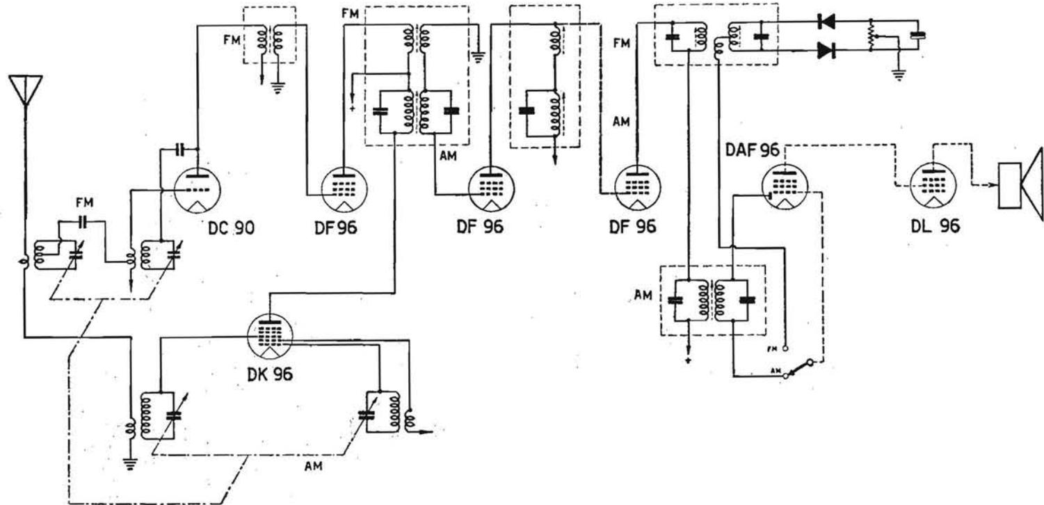
Fig. 3.21. - Negli apparecchi AM/FM di tipo portatile, la rivelazione FM è ottenuta con una coppia di cristalli di germanio.
