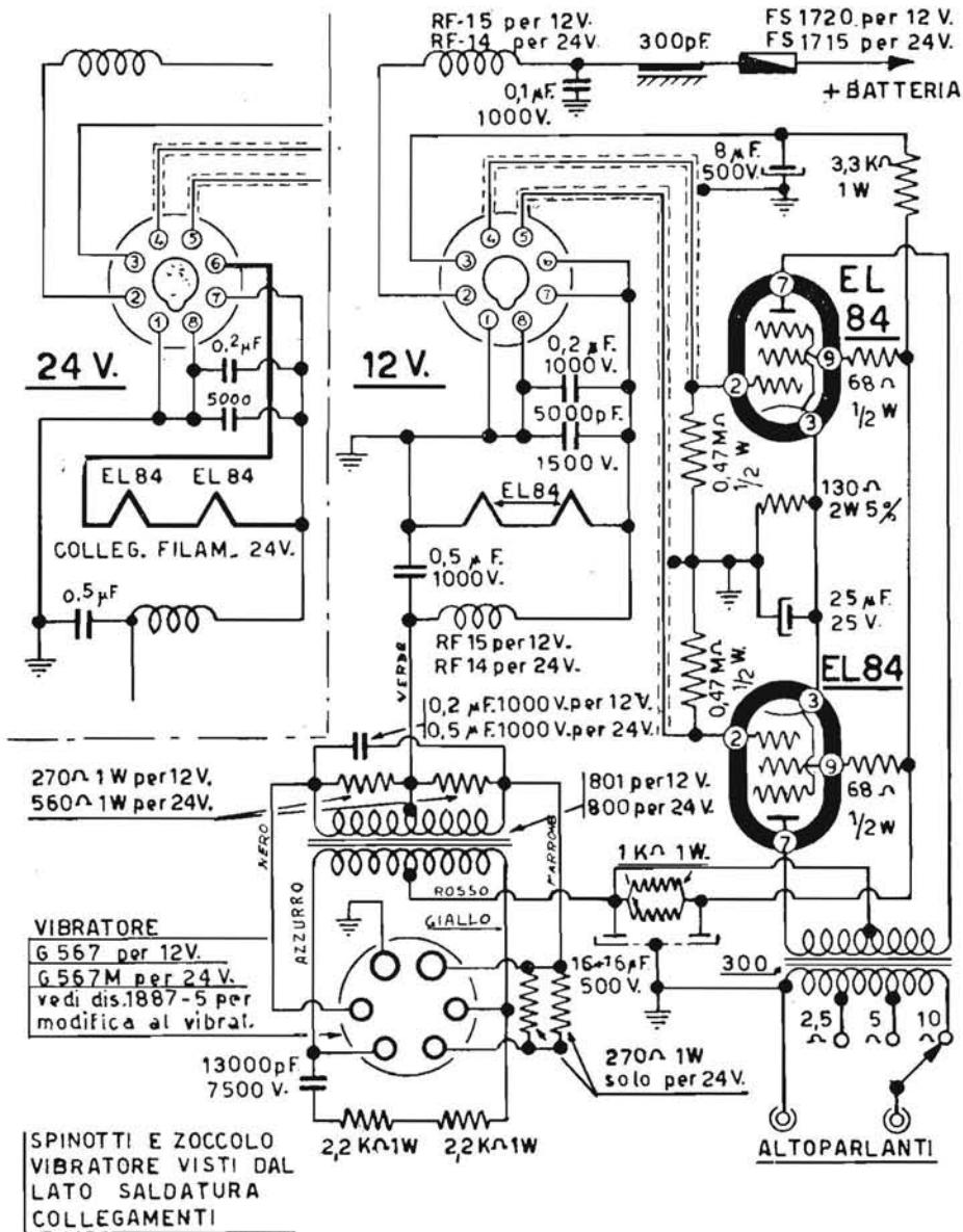
GALLO-CONDOR - Alimentatore e stadio finale per il sintonizzatore mod. 2114/T Pullman 10. Schema elettrico per 12 e 24 volt.
