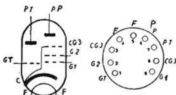
TRIODO AMPLIFICATORE E PENTODO FINALE. - Valvola noval adatta per più usi e particolarmente in apparecchi compatti a poche valvole, quale amplificatrice BF e finale di potenza. Adatta anche per stadi o BF in ricevitori TV.
