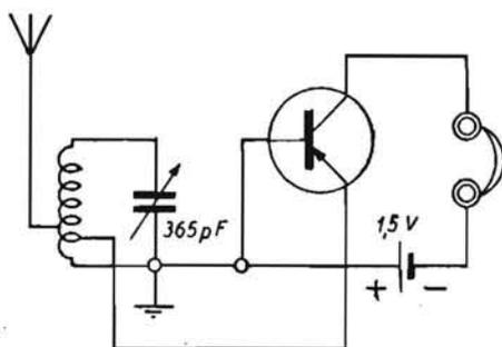
Fig. 1.26. - Semplicissimo apparecchio da taschino, con un solo transistor rivelatore in reazione. (Allied Radio, Chicago).
