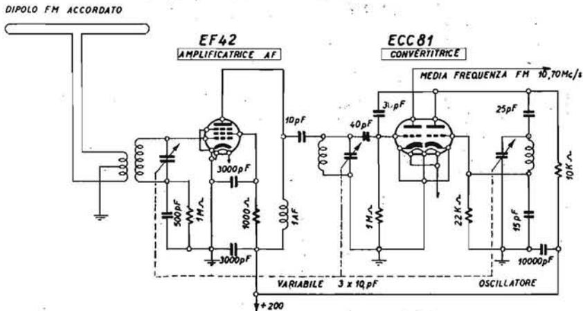
Fig. 3.30.- Tipico stadio di amplificazione AF/FM e di conversione di frequenza a 10,7 Mc/s, con doppio triodo.
