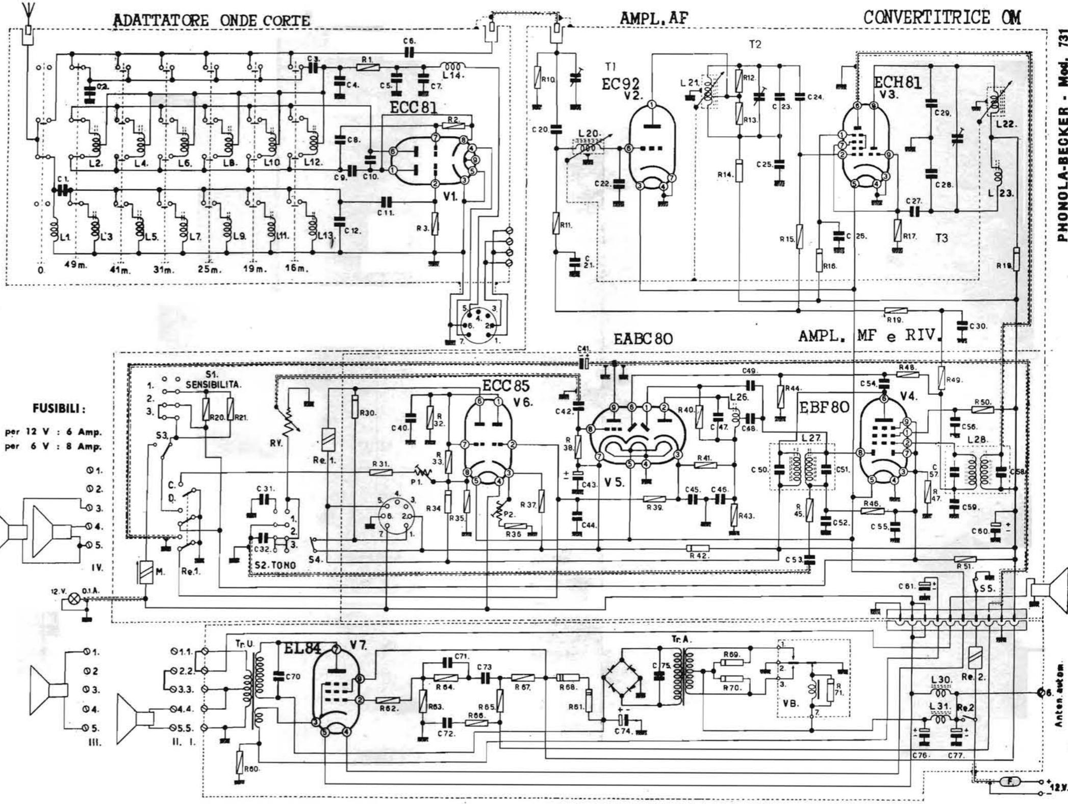
FIMI S. A. - Autoradio PHONOLA-BECKER mod. 731. Apparecchio con ricerca automatica delle emittenti, ottenuta con dispositivo elettronico (V5 e V6); l'indice si ferma sui trattini corrispondenti a stazioni ricevibili con tre gradi di sensibilità dell'apparecchio. Dispositivo per il comando a distanza. Adattatore per onde corte. Sintonia a permeabilità variabile. (V. retro caratteristiche e note di servizio).
