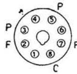
RADDRIZZATRICE BIPLACCA. - Tensione d'accensione: 6,3 V. Corrente d'accensione: 0,4 A. Erega 60 mA con 250/300 V di placca. Resistenza totale minima del circuito per ciascuna placca: 600 Ω.
